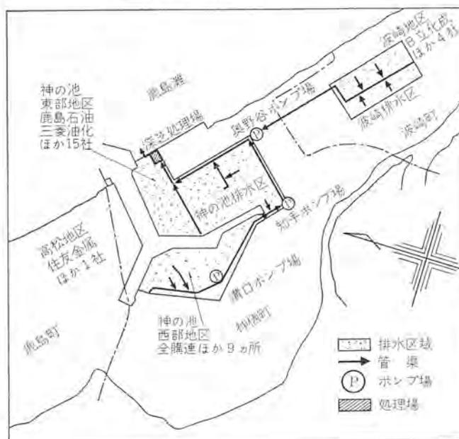
図 2.1 排水区域および下水道計画
