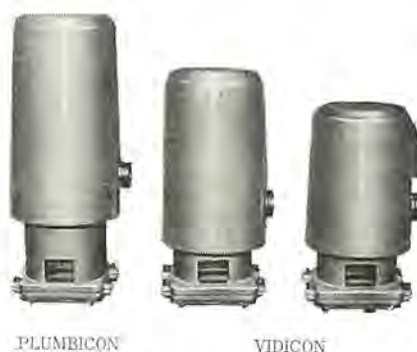
図 3.3 ビジコン用・プラumbicon用カメラ Vidicon camera and Plumbicon camera.
