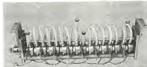
図 3.1 8 素子形油冷スタック Eight elements oil cooled stack.
