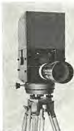
図 1.1 ITV 光伝送装置 Opto-electronic ITV transmitter.
