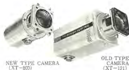
図 3.2 新形・旧形ビジコンカメラ New and old vidicon camera.
