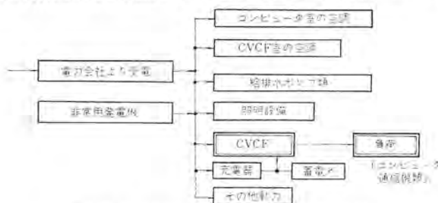
図 2.1 CVCFを含む受配電システムブロック図 Total system of non-break power supply.
