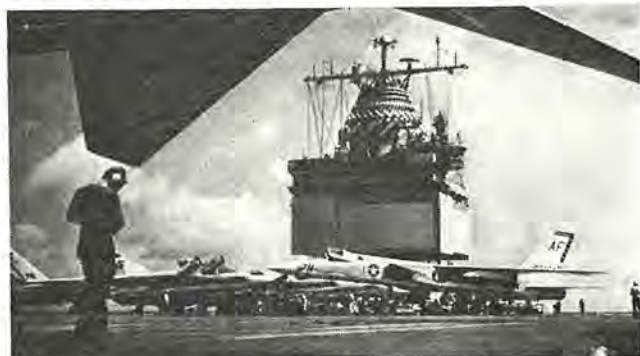
文献 [1.1.2] から (INTERAVIR 1965 年 12 月号) 図 8.1 空母 Enterprise 号上の SCANFAR (=AN/SPS-32+AN/SPS-33)
