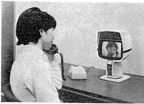
図 3.6 三菱テレビ電話 MVP-2 Mitsubishi TV Telephone MVP-2.
