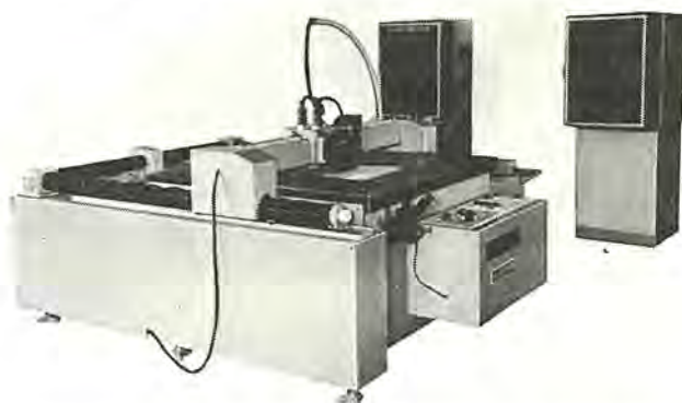
図 2. 2 自動製図機 (武藤工業社製) と制御装置 (MELDAS) Automatic drafters and control equipment.
