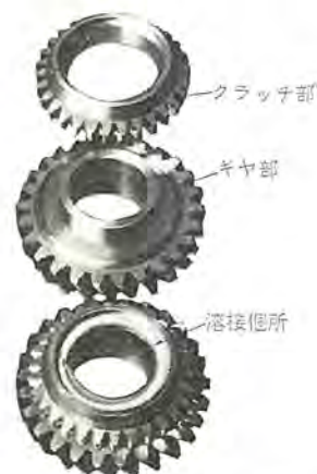
図 6. 1 自動車用歯車の溶接例 Example of welded gear.
