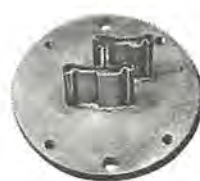
(d) 完成した電極(スリット加工は放電加工)
