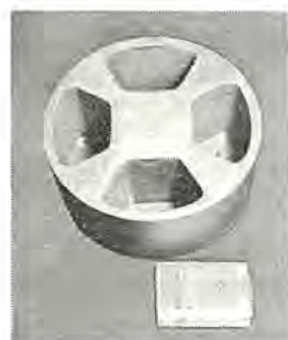
図 6. 17 マンドレルの加工例 Machining sample of the mandrel.
