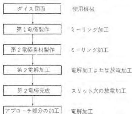
図 6. 20 アプローチ部分の加工工程 Machining process.
