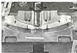
図 5.12 EDM 完了FRP 型 Die produced by EDM.
