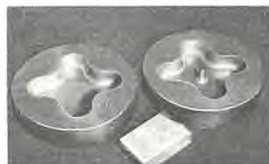
図 6. 19 ダイス裏穴加工例 Machining sample of the forming of die.
