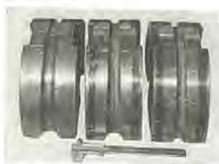
図 6.5 マスタと電解加工後の ロールダイス Master and pipe reducing roll machined by ECM.
