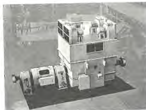
8,000 kW 三相誘導同期電動機
