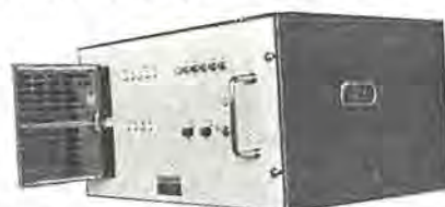
図 3.5 MELMIC-100 ROM 書き込み装置 Programmer of MELMIC-100.
