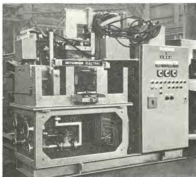
図 3. 7 ローラシャフト 自動高周波焼入装置 Automatic high-frequency hardening equipment for roller shaft.
