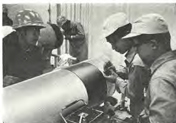
図 10. 1 JCR 2 段 ロケットブースタエンジンの超音波検査 Ultrasonic inspection of JCR 2 stage rocket booster engine.
