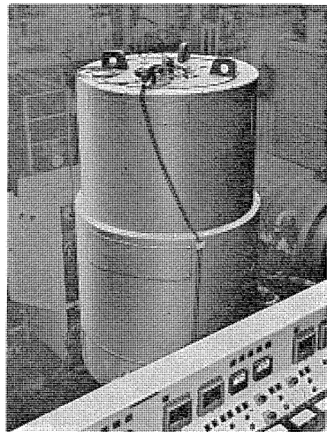
工場試験中の 400 kVA 10 kHz 高周波発電機
