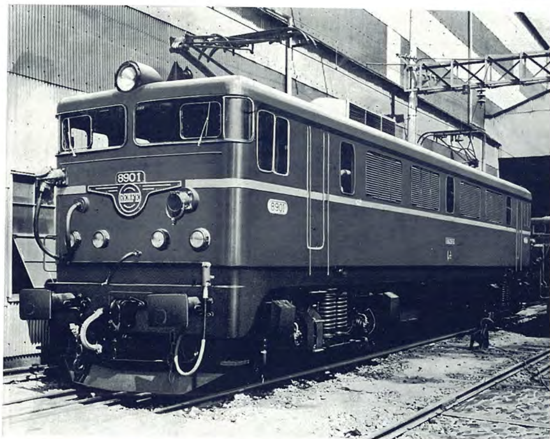
スペイン国鉄向け 3,100kW直流電気機関車 3,100kW D C electric locomotive for RENFE
