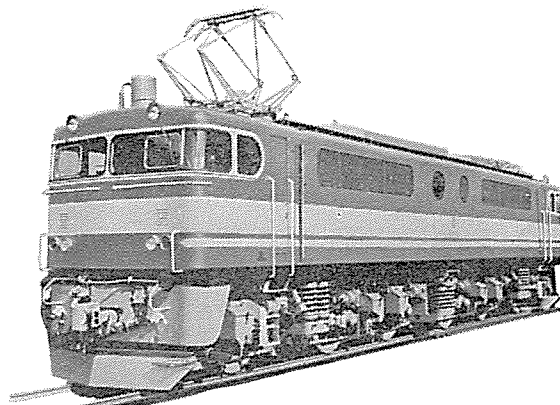
図 9.1 西武鉄道向け直流電気機関車 DC electric locomotives for Seibu Railway
