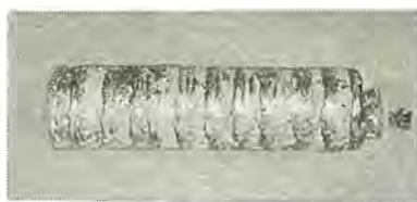
図 3.3 電子ビーム溶解した Ti-Nb-Ta 合金のインゴット Ingot of Ti-Nb-Ta alloy melted in an electron beam furnace.
