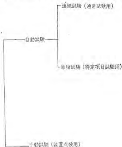
図 3.1 本装置による試験 Test method by the system.
