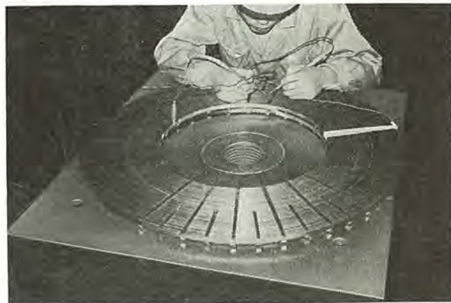
図 4.3 ターン間短絡試験 Inspection of layer short circuit.
