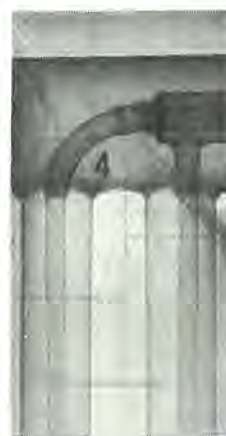
図 3.9 低温配管の X 線写真 X-ray photograph of low temperature helium gas piping
