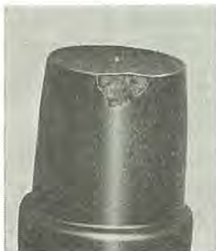
(a) 破れた電鍍電極
