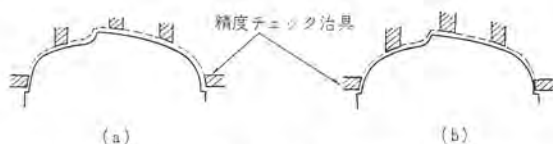
図 5.3 被加工物に対する精度 チェック 治具の当て方 Setting of check jig for electric-discharge-machined work.
