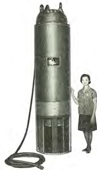
図 5.1 河川用水封式水中モートル Water-sealed type submersible pump motor, WSE-W 90 kW 14 P 3,000 V 50 Hz.
