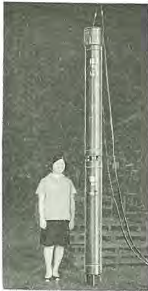
図 4.5 タンデム形深井戸水中モートル Tandem type submersible motor for deep well, WSB M10 75 kW 2 P 200 V/220 V 50/60 Hz.
