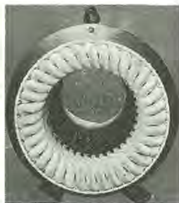
図3.2 コイルを組み込んだ固定子 Assembly of coils for stator.
