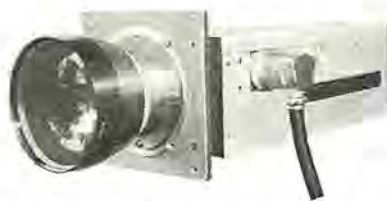
図 2.2 けい光板直接式 IO カメラおよびレンズ Image orthicon camera with lens for pickup of fluorescent plate.
