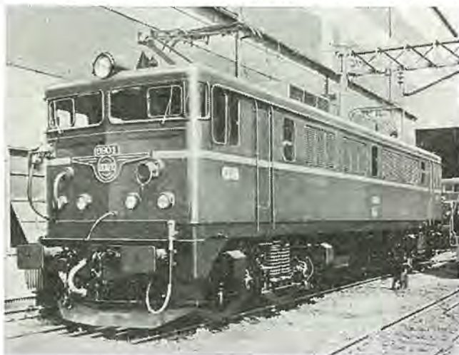
図 1.1 スペイン国鉄向け 3,100 kW 直流電気機関車 3,100 kW DC electric locomotive for RENFE.
