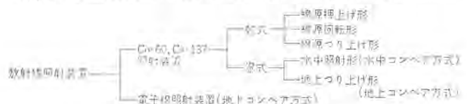
図 2.1 当社の放射線照射装置の種類 Table of kind of our irradiation units.
