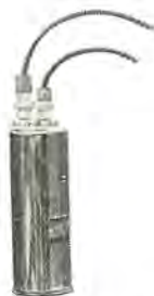
図 2.2 ND-1125 形 GM 検出器 GM counter head.
