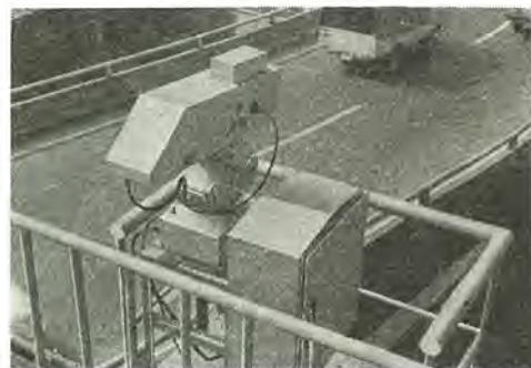
図 1 IT-T5 形 全天候形カメラ、全天候形 伏仰回転台および ITV 送信装置
