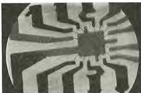
図 2.3 X 線に感度を有する ビジコン による IC 透視の受像画面 (10 kV 1.5 mA) TV picture with X-ray sensitive vidicon camera (10 kV 1.5 mA).
