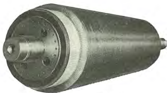
図 3. 4 油入電動機回転子 Rotor of oil-dipped motor.
