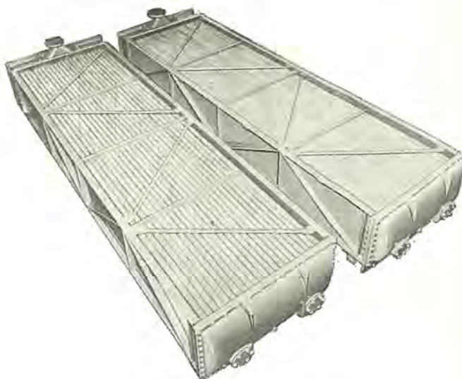
図 3.2 空気冷却器 Air cooler for water cooled motor.
