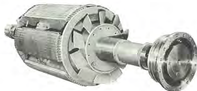
図 3.3 高速同期電動機の回転子 Rotor construction for high speed synchronous motor.
