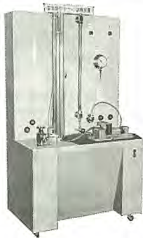
図 5.3 空気吸引漏えい試験装置 Air suction leakage test setup.
