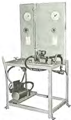
図 5.2 燃料圧漏えい試験装置 Fuel pressure leakage test setup.
