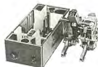
図 2.3 BU-2 形 内部構造 Interior construction of type BU-2.
