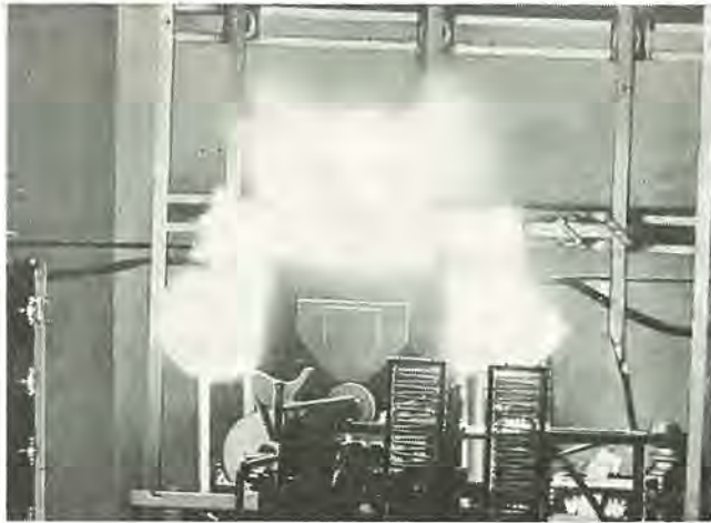
図 5.8 交流等価試験のしゃ断状況 (突進率 3 \times 10^3 A/S 推定短絡電流最大 値 100,000 A) AC equivalent interrupting test.
