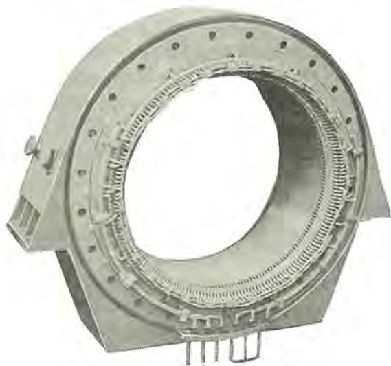
図 3.5 同期電動機の固定子 Stator of synchronous motor.
