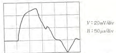
図 4.5 Min “1” パターン A におけるプリアンプ出力 Output of preamplifier at Min “1” pattern A.
