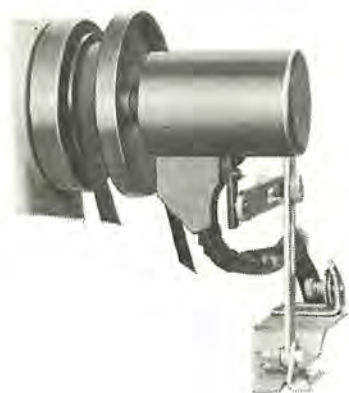
図 3.3 検出器 Needle positioning synchronizer.
