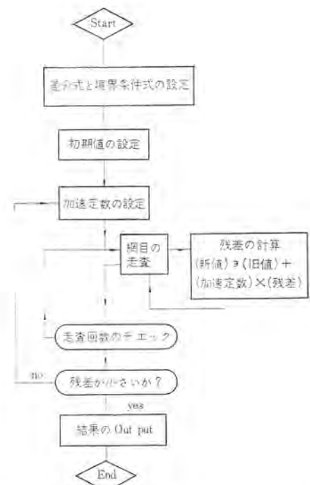
図 2.3 緩和法による計算フローチャート Flow chart for calculation by the successive over relaxation method.
