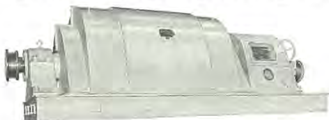
図 1.1 11,000 kW 4極 50 Hz, 6,000 V 全閉内冷形、巻線形 誘導電動機 11,000 kW 4 pole 50 Hz 6,000 V induction motor.
