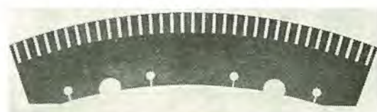
図 5.5 ピンタイプ回転子の扇形鉄心 Rotor segment core of pin type unit.
