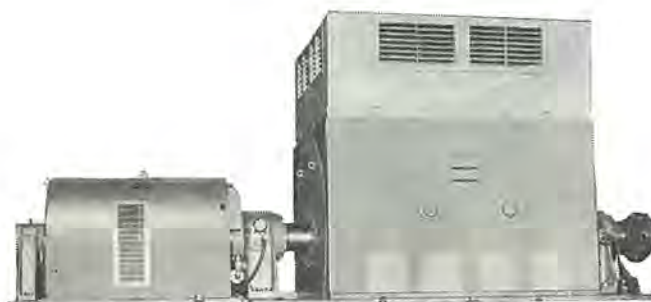
図 2.4 防滴保護形(サイレンサ付)同期電動機 4,100 kW 6 P 3,300 V, 1,000 rpm 4,100 kW drip-proof protected synchronous motor equipped with silencer.
