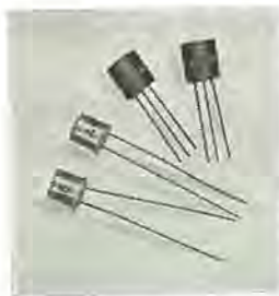
図 1.1 サイリスタ用トリガ素子外形 Exterior view of trigger devices for thyristors.
