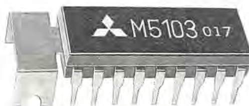
図 2.2 18ピンラジオ IC の外装 Exterior finish of 18 pin radio IC.
