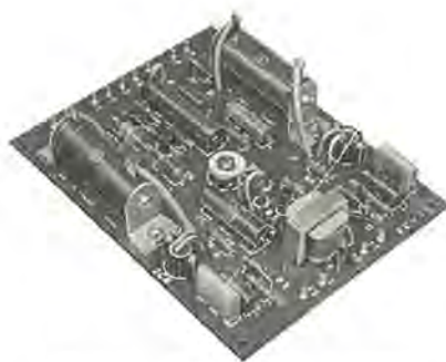
図 5.1 点弧回路 FC-1 L の外形 Outline of firing circuit type FC-1 L.
