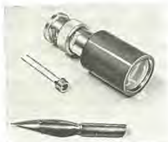
左は TO-46 ステムに取り付けキャップをしてある。 右は BNC-P-59 U に取り付けてあり、平行光線に対しては受光面積が 2,000 倍になる。
