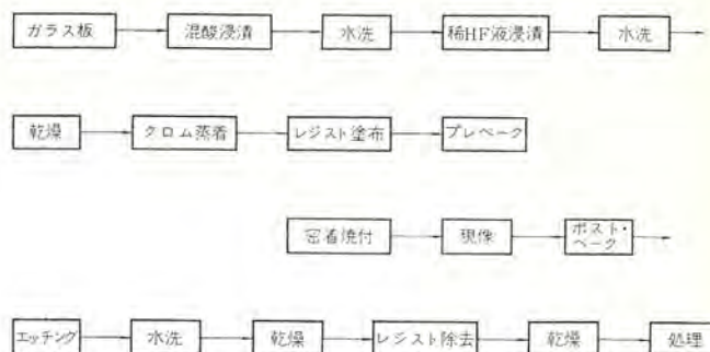
図 4.1 クロムマスクの製造工程 (6) Chrome mask making process.
