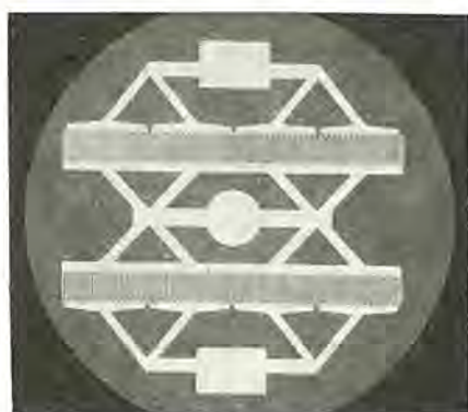
図 2.3 2SC1015 のパターン Transistor's pattern structure (2SC1015).
