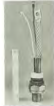
図 3.1 三菱大電力双方向サイリスタ BCR 150 A の外観 Appearance of Mitsubishi high power bidirectional controlled rectifiers BCR 150 A.
