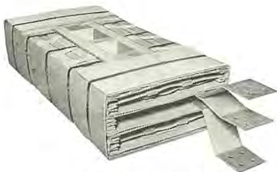
図 3.3 絶縁を施した高低圧 コイルグループ High and low voltage coils insulated.
