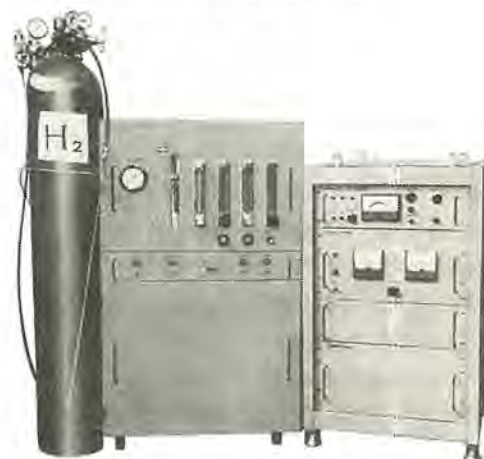
図 3.2 試作した FID の外観 Exterior view of developed FID.
