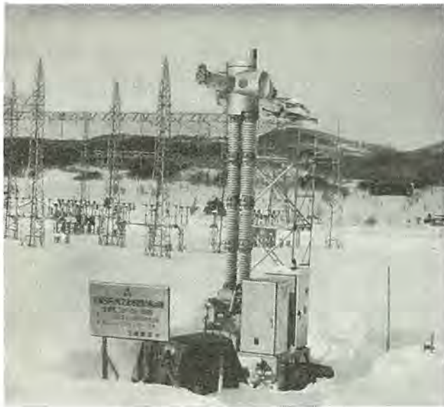
図 4.3 現地耐寒試験状況 Field test under cold atmosphere.
