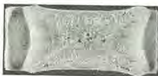
図 3.9 1 枚板におけるブローホールの発生 Macro photograph showing occurrence of blow holes in single plate.
