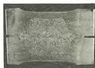
図 2.4 断面マクロ写真 (20 mm+20 mm) Macro photograph of weld nugget (20+20 mm).
