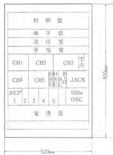
図 2.1 (c) 架実装図 Bay assembly of type ME-04 D 051 X.
