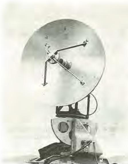
図 4.7 模型アンテナ (1.2 mφ)
