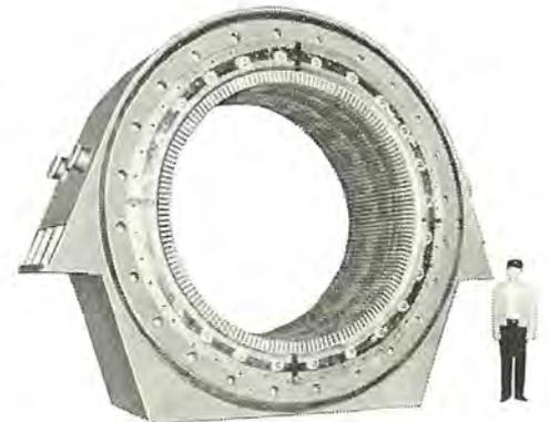
図2 10,000 kW 同期電動機用固定子フレーム
