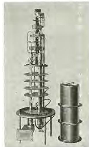
図 5.1 デュウビン冷却システムの外観
