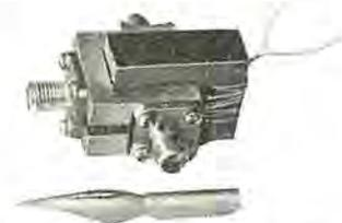
図 5.2 4 GHz 小形ストリップ線路ラッチングサーキュレータスイッチ
