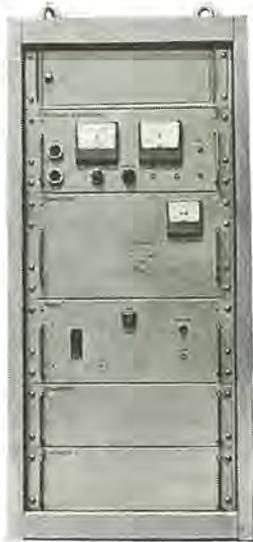
図1 サイリスタ無整流子電動機用電源
