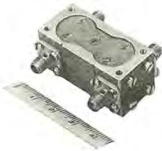
図 3.8 液体ヘリウム冷却小形4開口サーキュレータ
