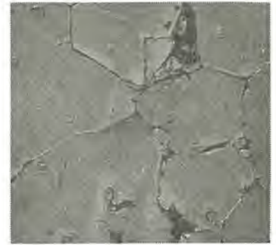
(c) 1,280°C 3時間焼結, 研磨後腐食 ( \times 1,500 )
