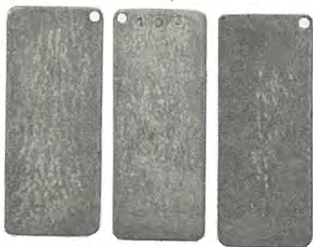
図 3.2 腐食試片表面のみぞ模様(1) (銅交流試験 55^{\circ}\text{C} 2.86\text{ mA/cm}^2 )
