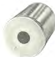
図 2.7 100 時間運転後のウェネルト電極 Example of wehnelt-electrode after 100 hrs operation.
