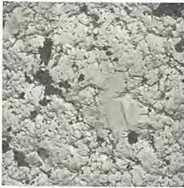
(a) 1,250°C 3時間焼結, 破断面 ( \times 1,500 )
