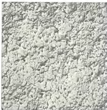
図 4.13 2 段レプリカ法電子顕微鏡観察による Ni-Zn フェライト 32 の組織, 1250°C 3 時間焼結, 破断面 ( \times 1,500 ) Electronmicroscopic structure of Ni-Zn ferrite 32 from a 2nd stage replica. Fired at 1,250°C for 3 h, cracked surface.
