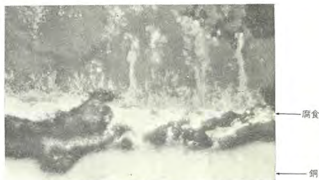
図 3.5 激しく腐食を受けた試片断面 \times 400 (銅交流試験 55^{\circ}\text{C} 15日間 2.86\text{ mA/cm}^2 ) 30\sim 50\mu corrosion depth with caves (AC test of copper 55^{\circ}\text{C} 15 days 2.86\text{ mA/cm}^2 ).
