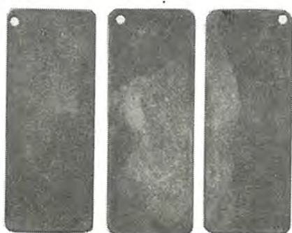
図 3.3 腐食試片表面のみぞ模様(2) (銅交流試験 85^{\circ}\text{C} 2.86\text{ mA/cm}^2 )
