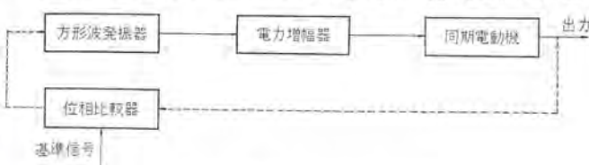
図 2.1 試作モータのブロック図 Driving system of brushless DC motor.
