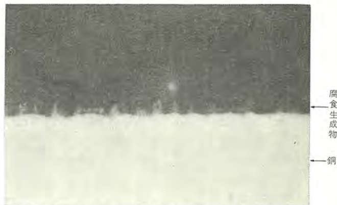
図 3.4 並立している腐食生成物 \times 400 (銅交流試験 55^{\circ}\text{C} 15日間 1.43\text{ mA/cm}^2 ) Corrosion products of 10\mu high. (AC test of copper 55^{\circ}\text{C} 15 days 1.43\text{ mA/cm}^2 ).
