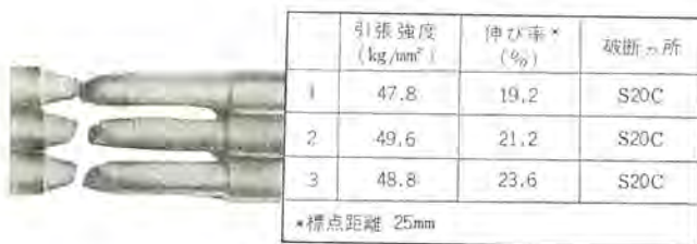
図 3.9 引張り試験結果 Ruptured test pieces in tensile test.
