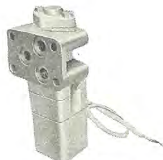
図 5.16 非常弁 Emergency valve.
