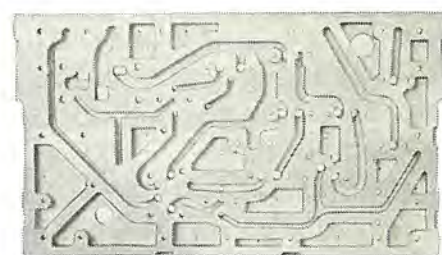
図 5.13 弁取付体 Piping base.
