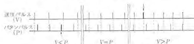
図 5.3 周波数比較の原理 Principle of frequency comparator.
