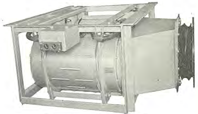
図 4.5 主フィルタリアクトル Main filter reactor.
