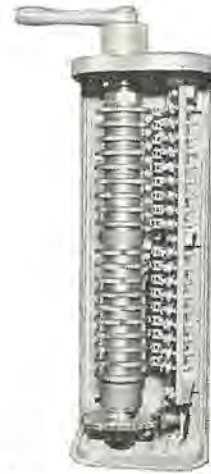
図 5.1 ブレーキ制御器 Brake controller consisting of cam type switches.
