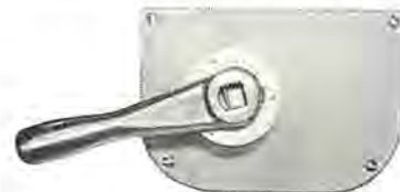
図 5.2 ブレーキ制御器上部 The upper part of brake controller.
