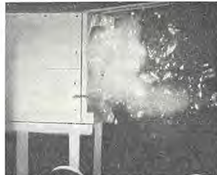
(c) 飛散 (かなりの重量のある破片がほとんど水平に打ち出されている)
