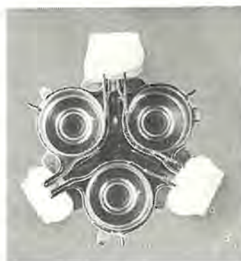
図 2.5 第一格子電極支持法 (改良形) Improved method of supporting G1 electrodes.
