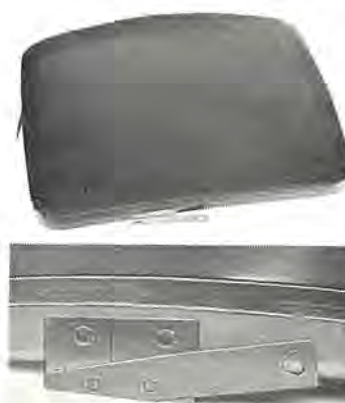
図 3.9 バイメタル使用のシャドウマスク Shadow-mask with bimetals.
