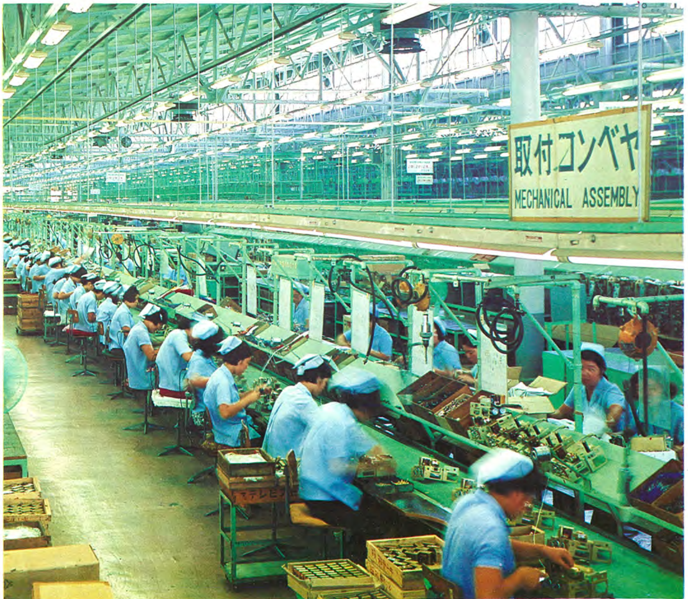
シャーシの組立 配線工程 (Assembling Process of chassis) 供給される部品は作業性を考慮して能率的に取付配線される
