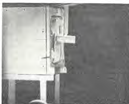
(b) パネルスカート部が膨張し同時に 画像面が陥没する
