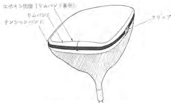
図 3.2 キムコード補強受像管 Picture tube with kimcode protection.
