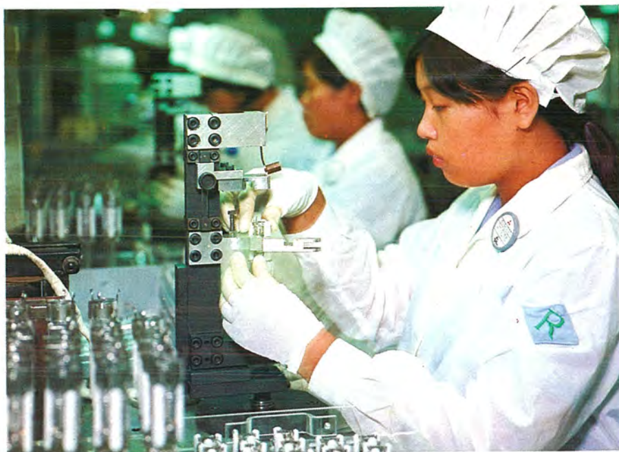
カラー受像管用電子銃組立て工程 (Mounting Process of Election Gun)
