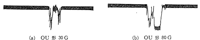
図 3.7 衝撃による接点のチャタリング状態 Chattering of contacts by shock.
