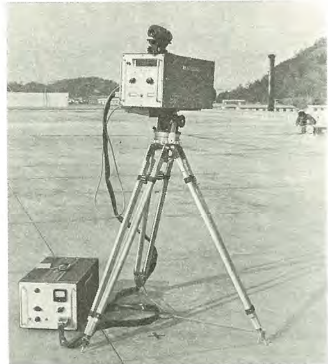
図 4.3 ジャイアントパルスレーザーを応用した測距装置 (三菱電機鎌倉製作所)
