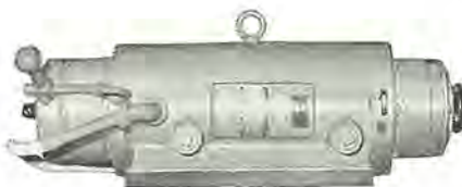
図 4.3 高周波三相誘導電動機 15 kW 2 P 300 V 150 c/s 全閉水冷立形 High frequency three phase induction motor.
