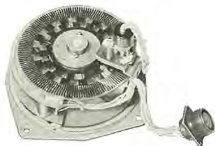
図 4.4 光電式パルス発信機（内部） Photo electric pulse generator (interior view).
