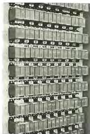
図 3.10 ならいシーケンス制御パネル Sequence control panel for copy.
