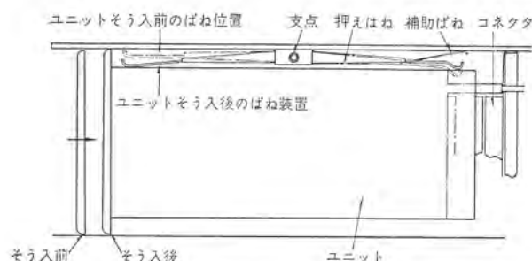
図 2.2 ユニットの耐振構造 Vibration-proof structure for unit.
