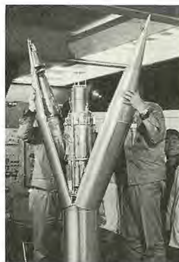
図 4.8 K-9 M-22 ロケットとう載磁力計のとう載状況 Rocket magnetometer installed in K-9 M-22 rocket.
