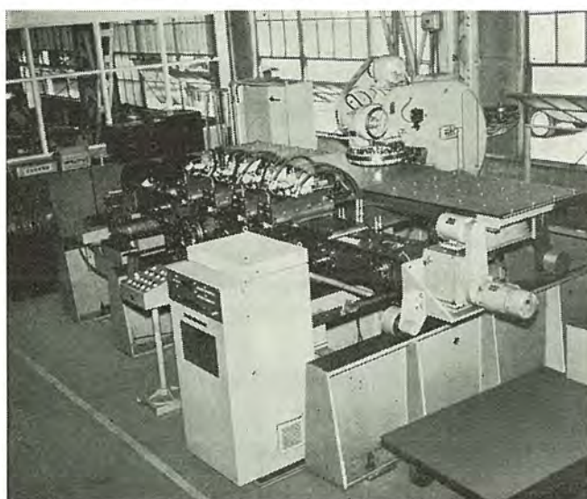
図 7.4 MELDAS-3300 ターレットパンチプレス MELDAS-3300, Turret punch press.
