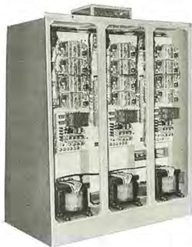
図 3.9 2 kW サイリスタサーボ増幅器パネル（3台分） 2 kW thyristor servo amplifier panel (included three set).
