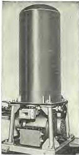
図 2 極低雑音増幅装置用循環式液体ヘリウム冷却系冷却装置本体外観
