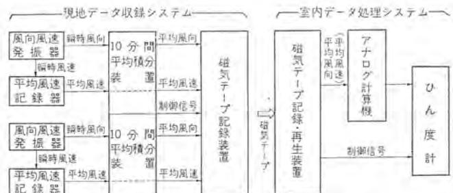
図1 風向・風速データ処理装置ブロック図
