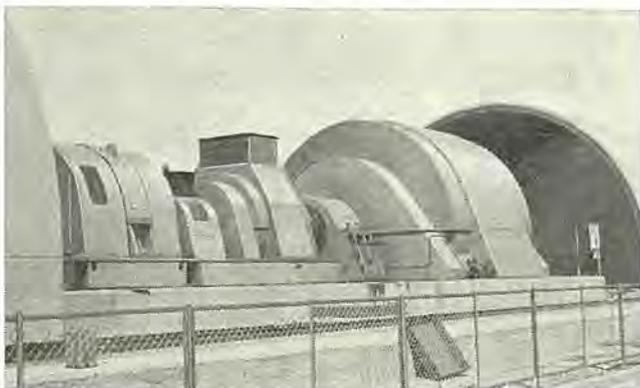
図 2.1 20 MVA 発電機駆動用レクチフロードライブ
