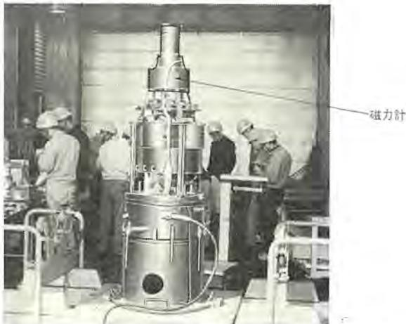
図 3.5 ロケット積載用磁力計 (高空の超低周波磁波観測用として東大宇宙航空研究所に納入されたもの)
