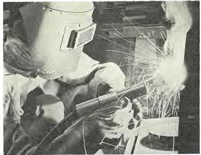
図 3.14 横向き溶接作業状況
