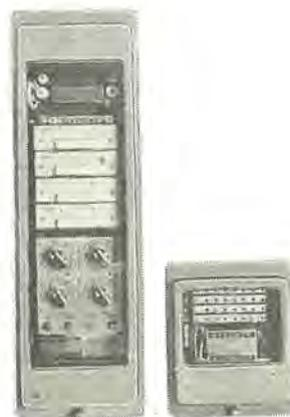
図 3.5 LAA-3 B-D 形積分形電圧調整継電器
