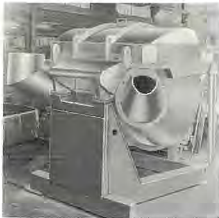
図 2.3 鋳鉄用 IRV みぞ形低周波誘導炉 IRV groove type low frequency induction furnace for cast iron.
