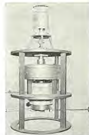
図 4. 2 立形軸受試験装置 Testing apparatus for vertical bearing.
