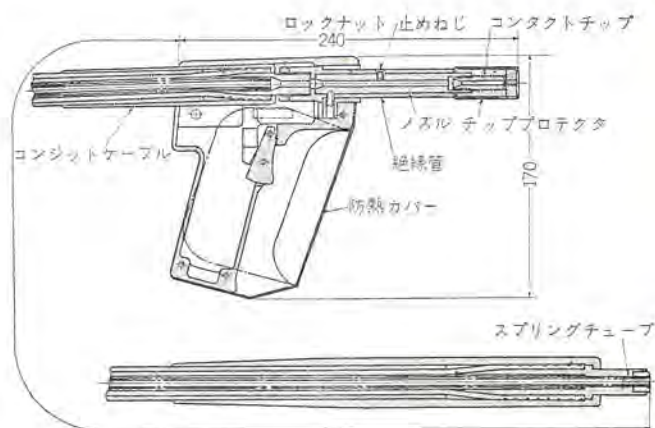
図 3.1 MV-501 形溶接トーチ Type MV-501 welding torch.
