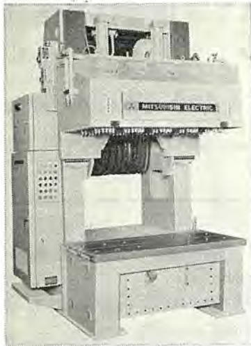
図 3.2 クラウン 昇降形 C フレーム プレスウェルダ (本体のみ) C frame press welder (without fixture).
