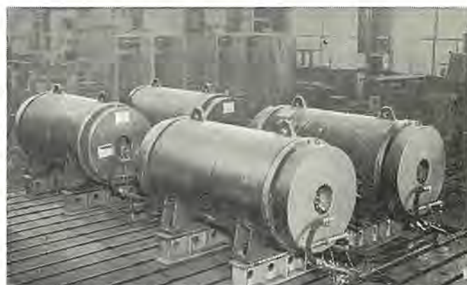
図 6.1 3 kc 300 kVA 機 4 台の並行運転 Parallel running of 4~3 kc 300 kVA high-frequency M-G sets.
