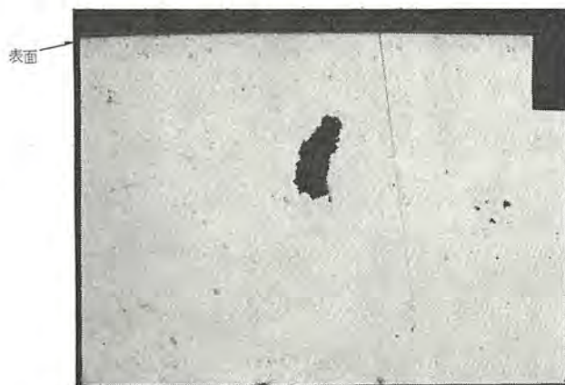
図 3.11 中空軸材断面における地きず (欠陥B) ( \times 100 )
