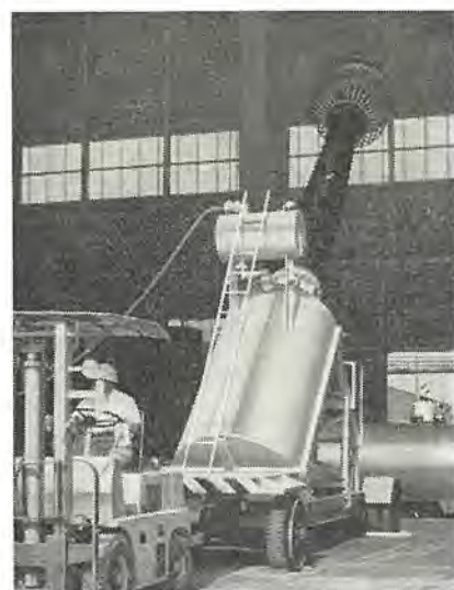
図 3.22 超々高圧 ブッシング 試験用 トレーラタンク EHV bushing test-tank.
