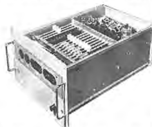
図 11.31 カラー VTR 用タイマ (MEC-100) Electronic tape timer for color video tape recorder.
