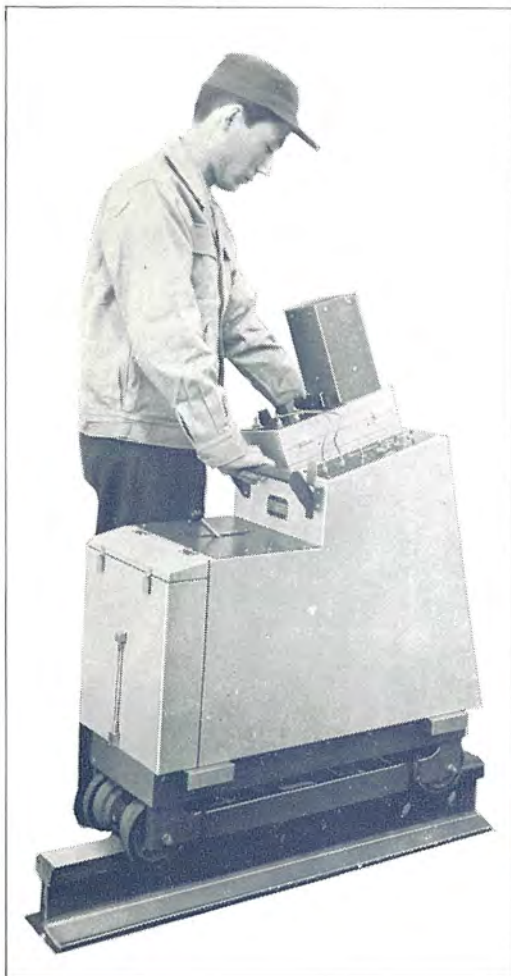
日本国有鉄道納めレール探傷器 Ultrasonic rail tester railscope for the J.N.R
