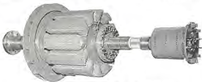
図 5.1 ブラシレス交流発電機回転子構造 375kVA, 450V, 12P, 600rpm.
