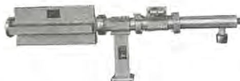
図 11.18 高域波、高次波除去 フィルタ 付き 4 Gc 帯偏分波器 4 Gc band polarization coupler with higher band and higher mode rejection filter.
