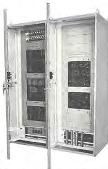
図 4. 108 インゴットバギー自動位置制御装置 Automatic position regulator for iron ingot buggy.
