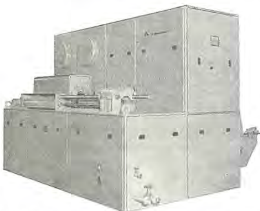
図 4.13 押出し用ビレットヒータ、EL-EP2形50c/s、410kW Billet heater for extrusion 50c/s, 410kW type EL-EP2.
