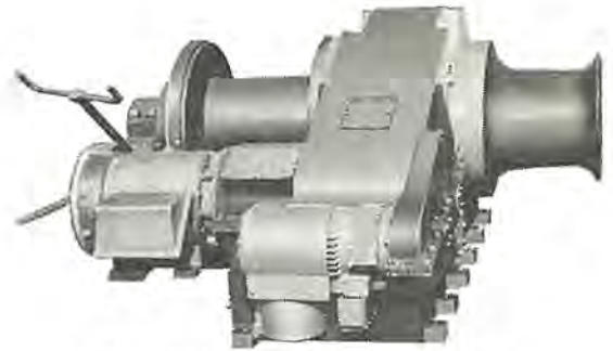
図 5.7 10 t×18 m 自動ムアリングウインチ Automatic mooring winch (10 t×18 m/min)
