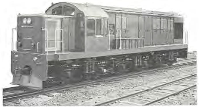
図 6.1 ニュージーランド国鉄納め ブラシレス 交流発電機式 ディーゼル 電気機関車 Diesel electric locomotive with brushless main alternator for the New Zealand government railways.
