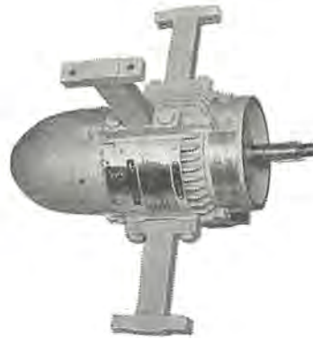
図 5.4 SE-EV 形 船用 E 種電動機 0.75 kW, 2p, 440 V, 60 c/s (軸流ファン用) Type SE-EV marine induction motor of class E insulation (for axial flow electric fan).
