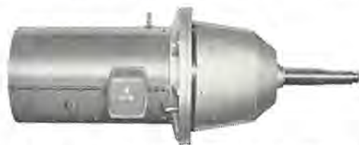
図 4. 9 ペル形焼鈍炉送風機駆動用三相誘導電動機 SE-FV-V 37 kW 4 P 2,500 Fr 400 V 50 c/s 周囲温度 60°C 軸先端温度 常温 480°C Type SE-FV-V three phase induction motor for bell type annealing furnace fan.
