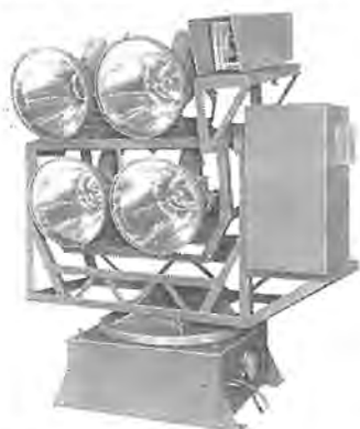
図 11.29 水門監視用 ITV と大形回転台 Flood gate observing ITV camera and pan-tilt unit.
