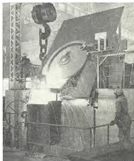
図 4. 16 12 ton 1,500 kW 低周波誘導炉 12 ton 1,500 kW low frequency induction furnace.
