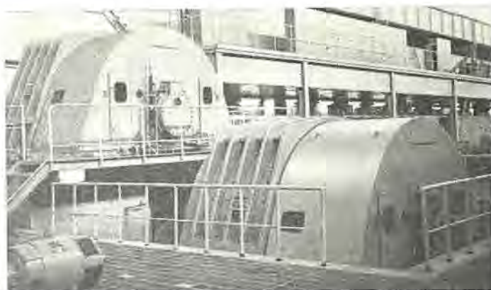
川崎製鉄(水島) 納めラレートミル 用主圧延電動機 Large DC mill motors for plate mill use.
