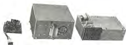
図 11.37 PT 650-A 形 テレメータ 送信装置 (左から副搬送変調器 1 チャンネル、電池、送信機) Type PT 650-A telemetry transmitter.
