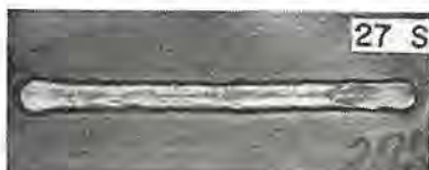
図 1. 32 定電圧方式によるビード形状 (400 A, 26 V) Weldment by the A. C. constant potential electric source.
