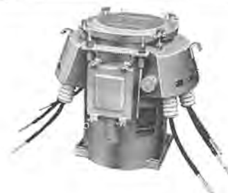
図 3.16 丸胴形 6 kV 計器用変圧変流器 6,600/110 V 10/5 A PT 2×15 VA CT 2×15 VA Cylindrical case type 6 kV combined transformer.
