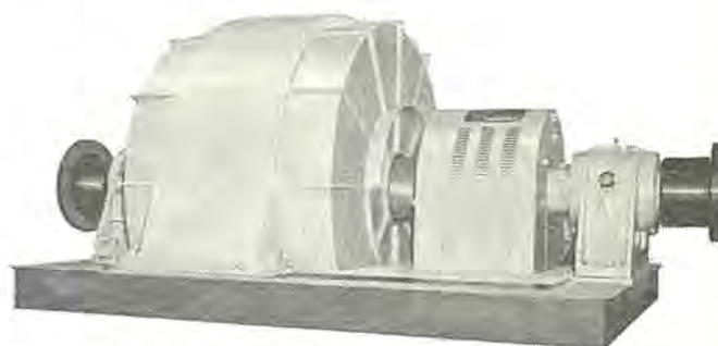
図 4. 6 八幡製鉄（君津）向け イルグナーセット用 11,000 kW 12 P 11,000 V 50 c/s 巻線形開放防滴他力通風形三相誘導電動機 Wound rotor type, drip proof pipe-ventilated three phase induction motor.
