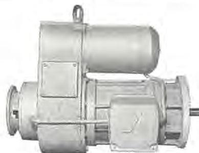
図 4.36 数値制御装置用親子モータ 親モータ SE-EF 形 400 W 12 P 200 V 50/60 c/s 三相誘導電動機 子モータ FK 形 200 W 2 P DC 110 V 他励磁直流電動機 高速…500/600 rpm 他連…100~5 rpm (減速比 1/20) Twin motor for numerical control.
