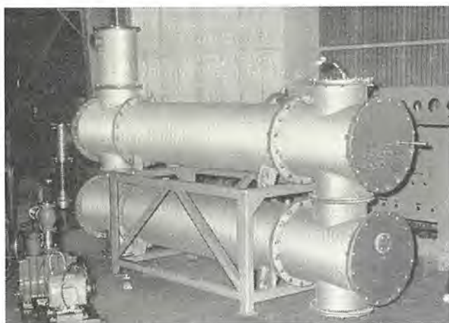
図 1.10 小形高効率熱交換器試験装置 Test apparatus of compact heat expander.
