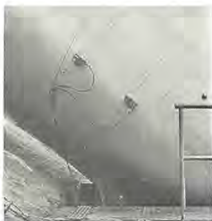
図 13.5 水圧鉄管にとりつけた超音波流量計発信器 および受信器 Supersonic flowmeter transmitter and receiver on the penstock.
