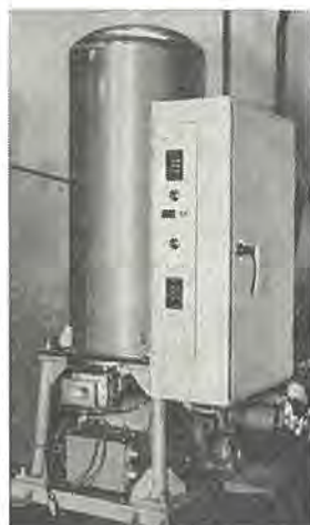
図 1.23 冷却パラメトリック増幅器内蔵循環式液体ヘリウム冷却器 Closed cycle liquid helium cryostat with parametric amplifier.
