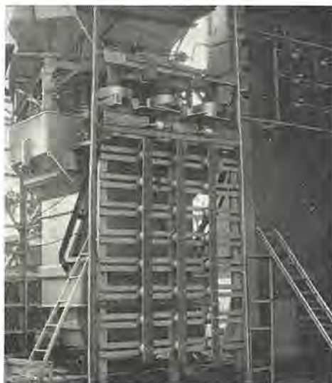
図3.47 500 V 200 kA しゃ断試験中の500 D 4,000 A ネットワークヒューズ 500 V 4,000 A Network fuses under testing of 500 V 200 kA interruption.
