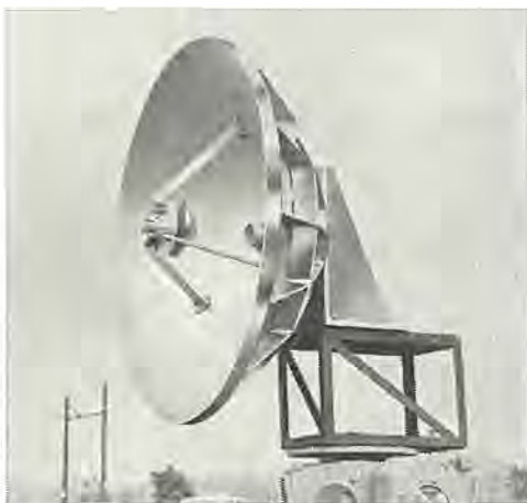
図 1.21 衛星通信用鏡面修整カセグレンアンテナの実験 Experiment on a shaped-reflector Cassegrain antenna for space communication.
