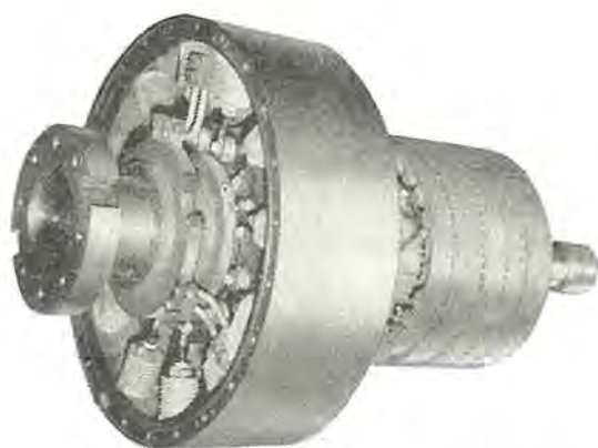
(b) 交流励磁機の回転電機子と回転整流器
