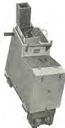
図 11. 42 レール探傷器 (Railscope FD-420) Ultrasonic flaw detector of rails. (Railscope FD-420)
