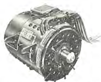
図 6.4 MT 915 形主電動機 (275 kW, 日本国有鉄道納め) Type MT-915 traction motor for JNR.
