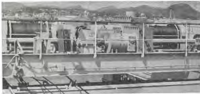
図 5. 9 ガントリクレーン用電機品 25t×23 m/min Driving unit for gantry crane.
