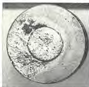
図 4.5 縦磁束のない場合のアークのこん跡 Traces of arc on an electrode surface without the magnetic field.
