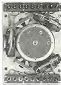
図 2.5 CNM-1 形主制御 継電器 (内部) Type CNM-1 master relay (internal construction).
