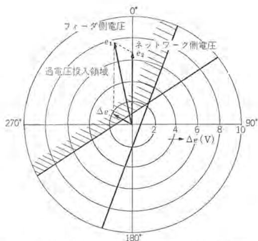
図 3.2 ネットワークプロテクタ 過電圧投入特性の例 Typical closing characteristics of network protectors.
