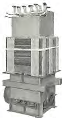
図 5.4 車両用変圧器の中身構造 Interior view of transformer.
