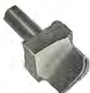
図 3.9 電極 Electrode for nozzle ring.
