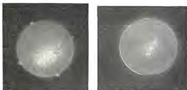
入力 221 Joule 出力 1 MW (固体 Q-スイッチ使用) ルビー 1/4 \phi \times 3" 反射鏡反射率 98%, 40 % (a) 拡散面反射筒を用いたときの Near Field Pattern 入力 265 Joule 出力 0.3 MW (固体 Q-スイッチ使用) 反射筒以外(1)と同じ (b) 金属鏡面円筒反射筒を用いたときの Near Field Pattern
