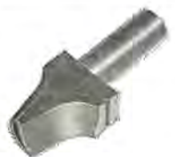
図 3.7 中仕上加工用電極 Middle finishing electrode.
