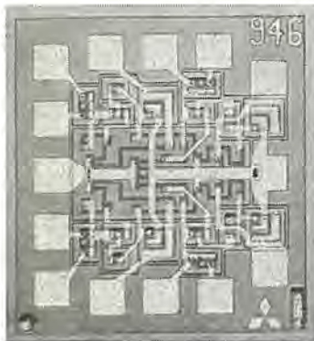
図 6. 1 M 5346 P Quadruple 2-input NAND gate のパターン写真
