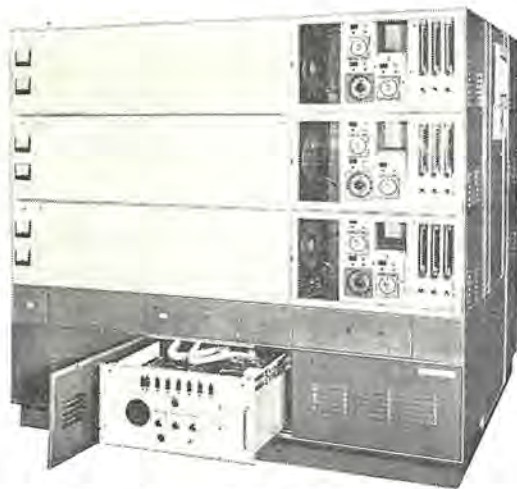
図 4.3 不純物添加装置と拡散炉 Fig. 4.3 Furnace with doping system.
