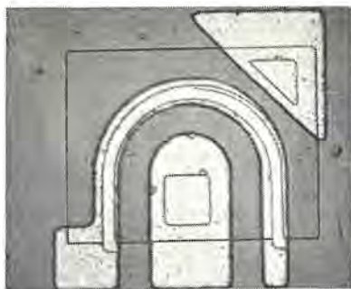
図 5.2 MOS トランジスタのパターン Fig. 5.2 MOS-transistor pattern applied to SOS.
