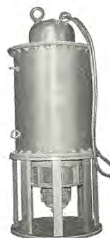
高圧水中モートル WSE-W 形 240 kW 4 P 3,000 V 50 c/s Y-Δ 起動方式
