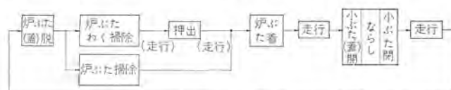
図 2.1 コークス押出機の運転プログラム Fig. 2.1 Program running of coke pusher.
