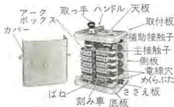
図 5.1 CN 形制御器 Fig. 5.1 Type CN controller.
