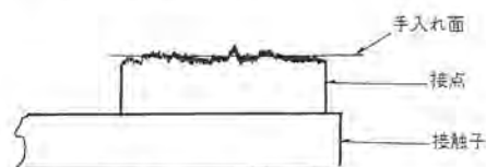
図 4.2 接点手入れ法 Fig. 4.2 Mending of contacts.
