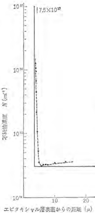
図 3. 3 エピタキシャル層の不純物濃度こう配の制御 Fig. 3.3 Impurity profile control of epitaxial layer.
