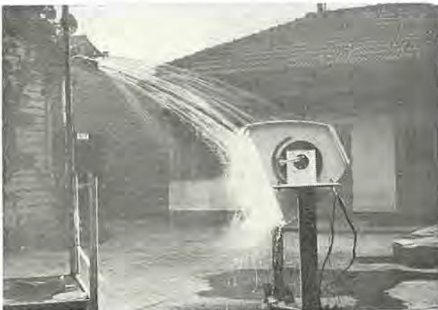
図 4.7 16kW キセノン 投光器の注水試験状況 Fig. 4.7 Water pouring test of projector.
