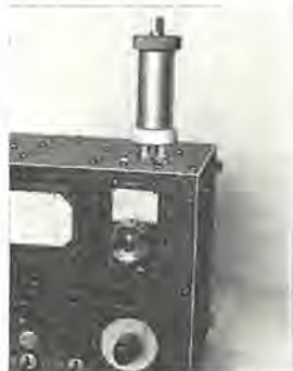
図 2.2 Qメータに短絡同軸空洞を取りつけた状態。(空洞の下からのぞいているテフロン棒は試料取出し用である) Fig. 2.2 View of coaxial cavity mounted on a Q meter terminal.
