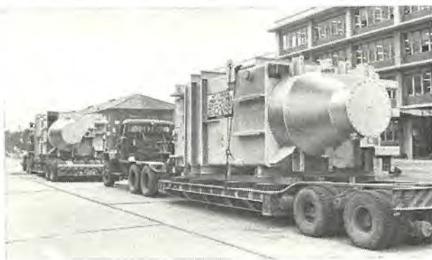
図 6.1 トレーラで輸送中の 400 kV 変圧器本体
