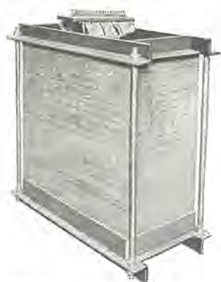
図 4.6 35 MVA 400 kV 分路リアクトル 縮尺モデル Fig. 4.6 Reduced scale model of 35 MVA 400 kV shunt reactor.
