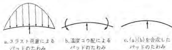
図 4.22 単純ピボット支持パッドのたわみ
