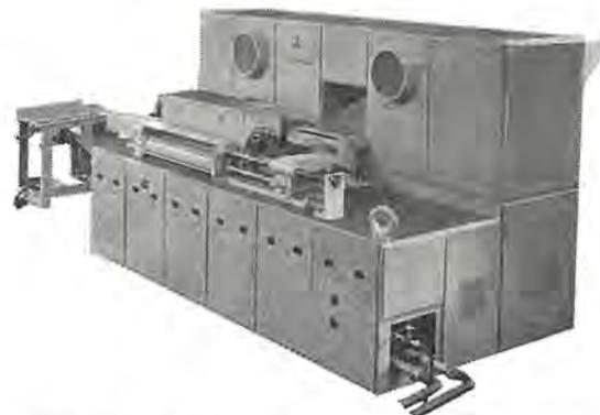
図 4.8 特殊金属用3相低周波ピレットヒータ 50 c/s, 3φ, 700 kW
