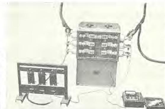
図 3.54 ネットワークリミッターシヤ断試験状況
