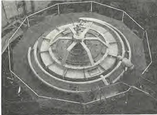
図 2.15 大形スラスト軸受モデル試験装置外観
