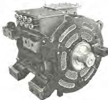
図 6.5 MT 56 形主電動機 (650 kW 日本国鉄納め)
