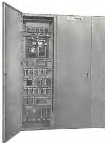
図 4.82 自動板厚制御盤
