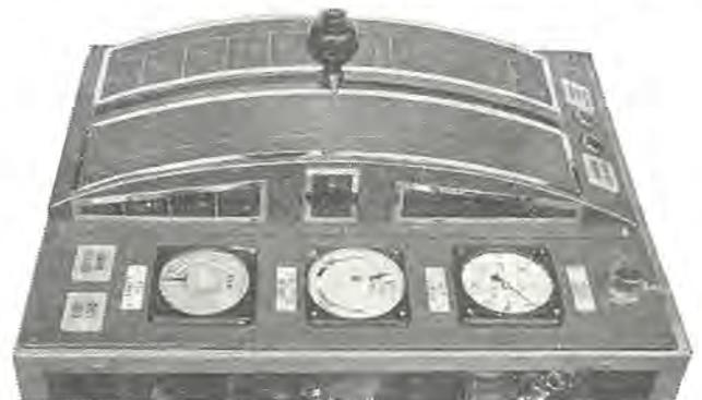
図 5.12 電気空気式主機ディーゼル遠隔操縦台
