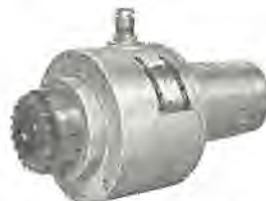
図 4.48 サーボドライブユニット駆動モートル
