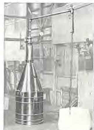
図 10.12 ヘリウムコンテナ および低温移送管
