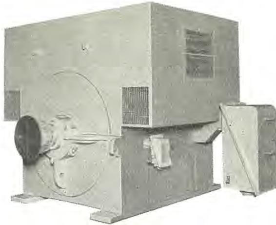
図 2.10 中国電力納め誘引通風機用 U Line 形防滴保護形屋外形三相誘導電動機
