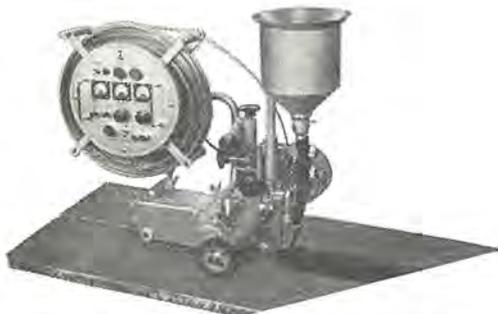
図 4.14 軽量自走式サブマージ溶接機
