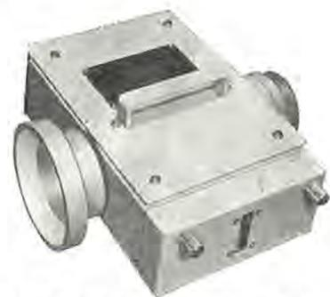
図 11.7 7 Gc 帯トンネルダイオード増幅器
