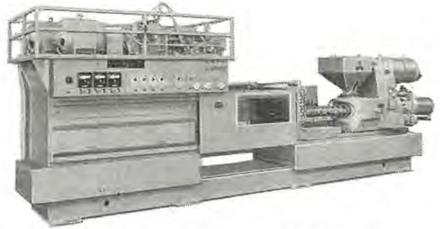
図 4.97 三菱重工製 スクリューラム 射出成形機
