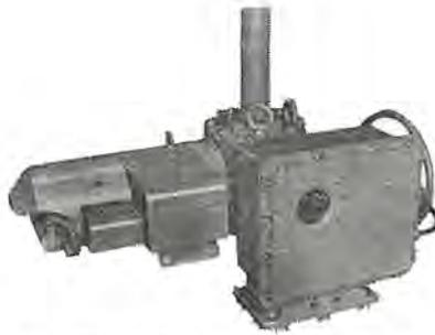
図 4.54 MVC-310 X 形バルブモートル
