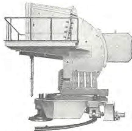
図 15.9 大形反応分析電磁石装置
