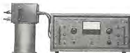
図 14.21 ヘリウムガス純度計
