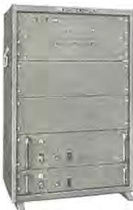
図 13.4 デジタル ATC 式速度照査器試作セット外観
