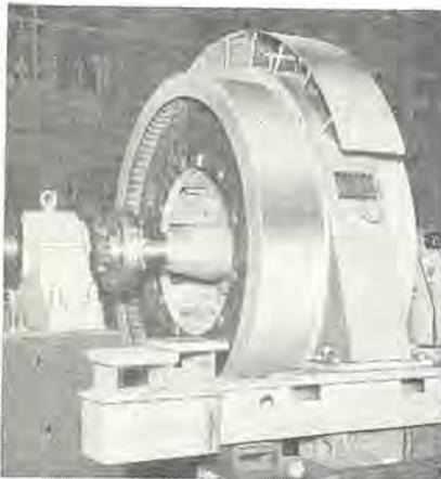
図 4.23 980 kW 往復動圧縮機駆動同期電動機
