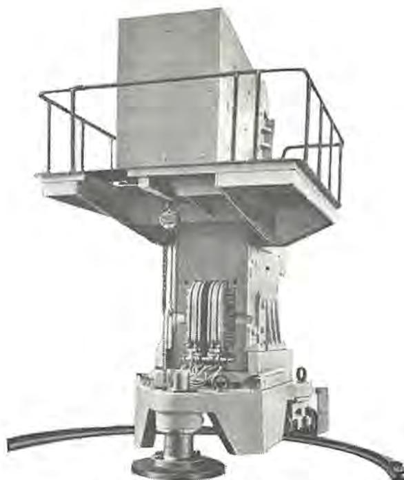
大形反応分析電磁石装置（東北大学納め）
