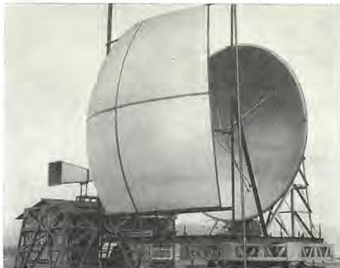
図 11. 12 サンドイッチパネルの散乱波レベル測定
