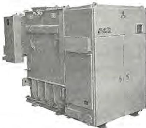
図 4.62 鐘淵化学納め 6,500 kW 325 V 20,000 A
