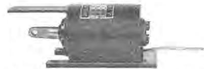
図 7.13 電磁アクチュエータ (12.5 V DC, 1.75 A 以下, 1 kg 以上 [吸引力])
