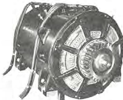
図 6.6 MB-3200-A 形主電動機 (1,350 kW スペイン国鉄納め)
