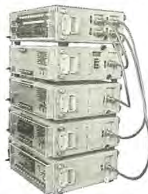
図 2.2 PHR 形可搬式継電装置(側面) Fig. 2.2 Type PHR portable relay scheme. (side view)
