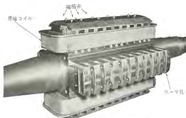
図 2.5 クシ歯方式の軸 Fig. 2.5 Rotor shaft of pin-type machine.
