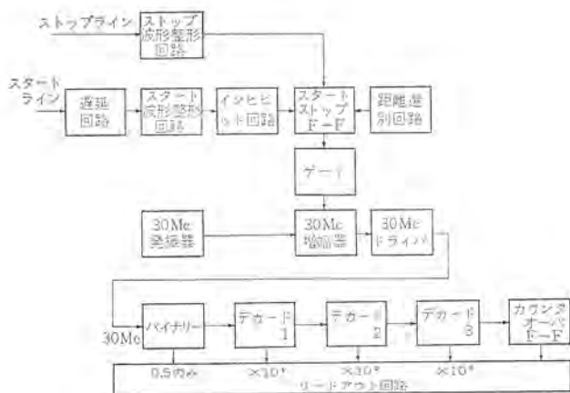
図 3.6 高速カウンタおよび表示部のブロック図 Fig. 3.6 Block diagram of high speed counter and display unit.
