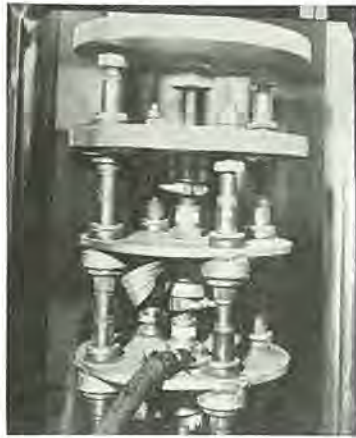
図 3.5 静圧縮荷重長時間負荷試験中の整流素子 Fig. 3.5 Life test of silicon diode.
