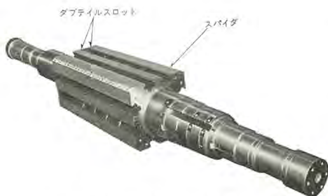
図 2.4 ダブテイル方式の軸 Fig. 2.4 Rotor shaft of dove-tail type machine.
