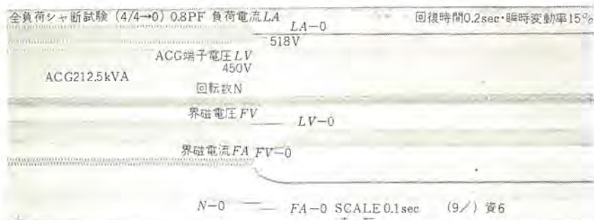
図 5.2 全負荷シャ断試験 Fig. 5.2 Full load interruption test.
