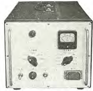
図 4.3 電源部 Fig. 4.3 Power supply unit of laser range finder.
