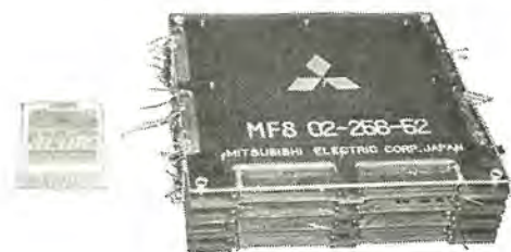
図 4.4 試作メモリスタック Fig. 4.4 Appearance of the memory stack.
