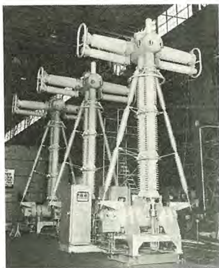
240 kV, 10,000 MVA, 1,200 A SF 6 ガスシ断器工場組立状況
