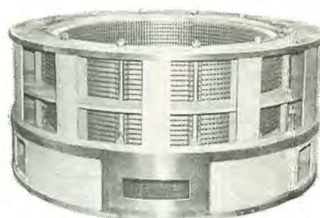
図 3.5 固定子 Fig. 3.5 Stator.
