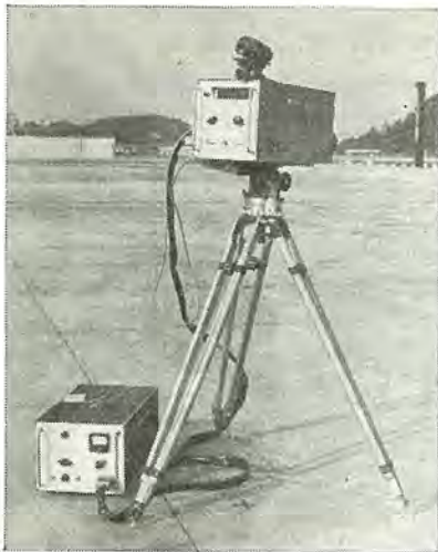
図 4.1 レーザ測距装置 Fig. 4.1 Laser range finder.
