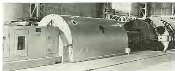
図 1.2 日本カーバイト魚津納め 15,625 kVA、3,600 rpm ブラシレスタービン発電機 Fig. 1.2 15,625 kVA, 3,600 rpm brushless turbine generator delivered to the Nihon Carbide Co., Uozu Works.
