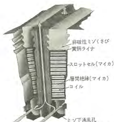
図 4.6 回転子コイルおよびミソ下通風説明 Fig. 4.6 Rotor coil and ventilators under the slots.
