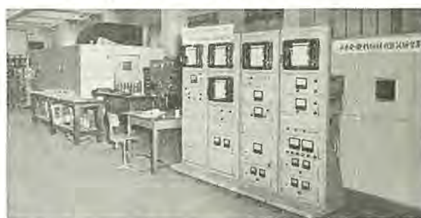
図 2.2 絶縁総合機能試験装置全景 Fig. 2.2 Insulation functional test equipment.
