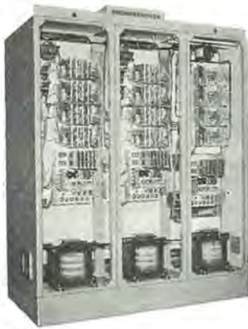
図 3.18 2kW サイリスタサーボアンプパネル (3 台分) Fig. 3.18 2kW thyristor servo amplifier panel (included three set).
