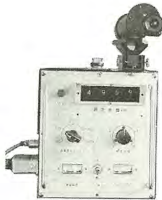
図 4.2 測距部 Fig. 4.2 Ranging unit of laser range finder.
