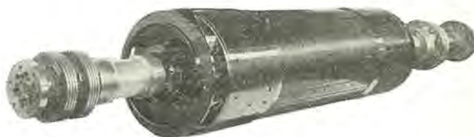
図 4.5 組立完成した回転子 Fig. 4.5 Completely assembled rotor.
