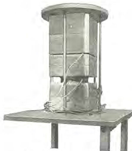
図 4.1 磁束分布測定用モデル Fig. 4.1 Device for measuring the magnetic flux distribution.
