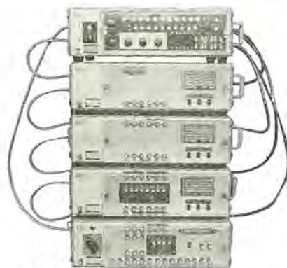
図 2.1 PHR 形可搬式継電装置 Fig. 2.1 Type PHR portable relay scheme.
