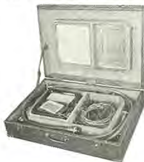
図 2.2 PHR 形可搬式継電装置(側面) Fig. 2.2 Type PHR portable relay scheme. (side view)
