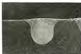
(c) 15 kV 450 W 98 mm/min ステンレス 板×1/2.8 (EBM D Gun).
