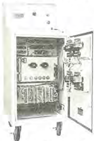
図3.6 サイリスタレオナード制御装置 Fig. 3.6 Thyristor leonard control panel.
