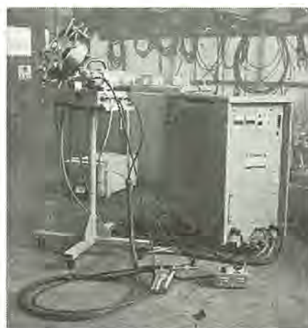
図 2.2 SA-250形半自動溶接装置 Fig. 2.2 Type SA-250 semi-automatic arc welder.
