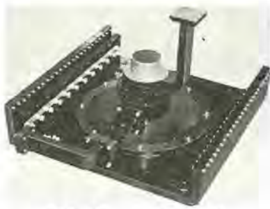
図 3.12 で き 上 り Fig. 3.12 Wave guide type radiator.
