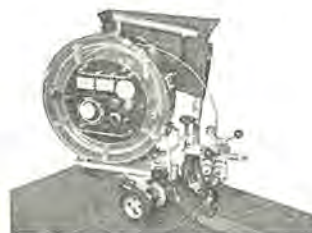
図 3.9 軽量自走式サブマージ溶接機 Fig. 3.9 Light weight submerged arc welder.
