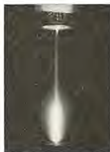
図 4. 1 高周波振動領域における放電状態 Fig. 4. 1 Discharge in high frequency oscillation region.
