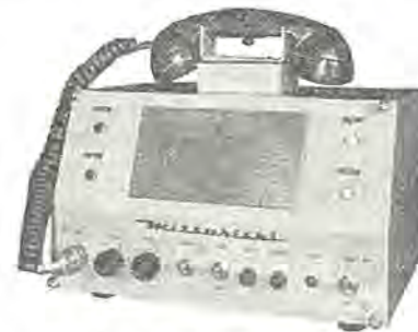
図 5.10 遠隔制御器外観 Fig. 5.10 Control box of radio equipment.
