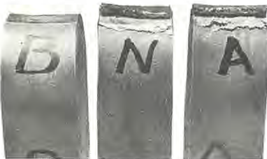
図 4.6 表曲げ試験結果 Fig. 4.6 Test pieces in giuded face bend test.
