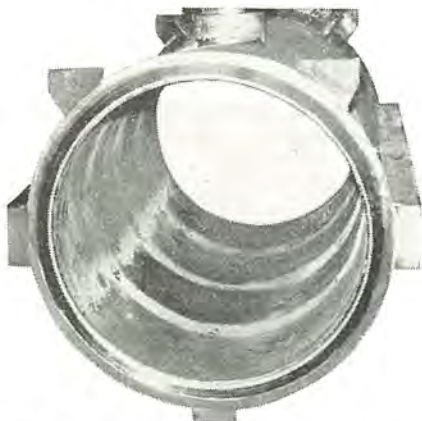
図 5.8 機械加工完了した空洞 Fig. 5.8 Inside view of cavity machined.
