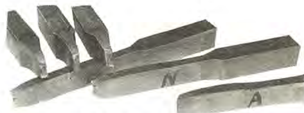
図 4.2 引張試験結果 Fig. 4.2 Ruptured test pieces in tensile test.
