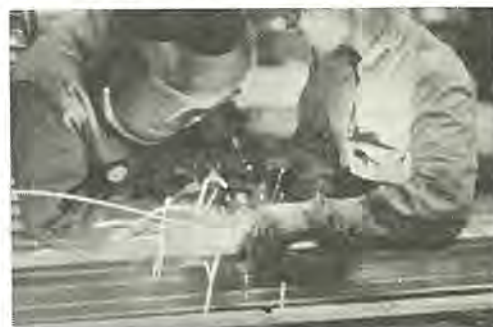
図 3.5 SA-100 形のアルミサッシ溶接への適用例 Fig. 3.5 Application to Al sash welding of type SA-100.
