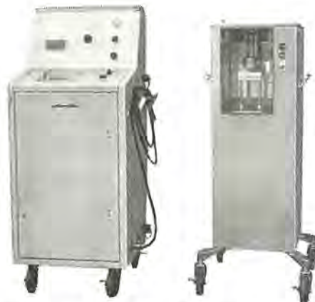
図 3.1 注入装置 (左、制御装置、右、動作器) Fig. 3.1 Injector (left, control device, right, Injector)
