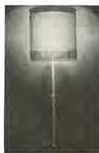
図 4. 4 直径 40 mmφ の陰極を使用したときの放電状態 Fig. 4. 4 Discharge by the cathode with an external diameter of 40 mm.
