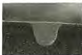
(b) 11 kV 275 W 96 mm/min ステンレス 板×1/2.8 (EBM D Gun).
