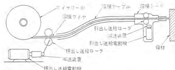
図 3.3 プッシュプル形ワイヤ送給方式 Fig. 3.3 Push pull type wire feed system.
