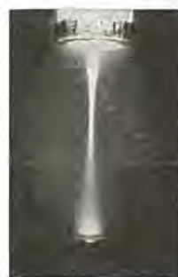
図 4. 3 高インピーダンス負特性グロー領域および高インピーダンス正特性グロー領域における放電状態 Fig. 4. 3 Discharge in high impedance negative and positive characteristic glow region.
