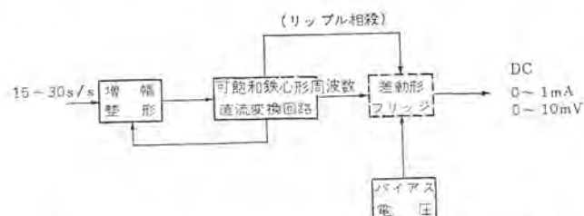
図 5.1 (b) TM-R4 形受量器回路系統図 Fig. 5.1 (b) Block diagram of type TM-R4 receiver.
