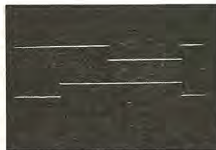
図 4.7 クール、ヒートゲートの出力波形 Fig. 4.7 Output wave form of cool gate and heat gate.
