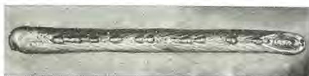
(b) 溶接電流 200 A, 電圧 27 V, 溶接速度 150 mm/min
