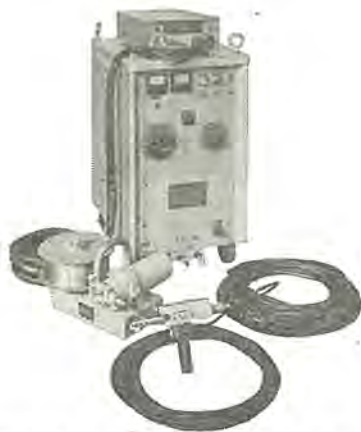
図 3.6 SA-300 形半自動溶接装置 Fig. 3.6 Type SA-300 semi-automatic arc welder.
