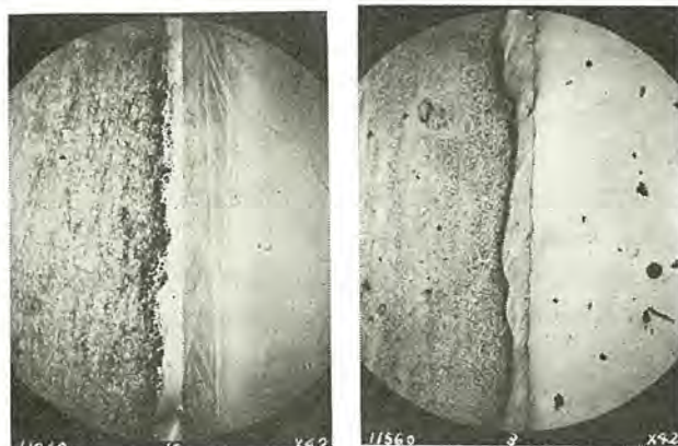
(a) 電気炉 (b) 高周波 条件 材質 SS41とSUS27(右) ろう材 無酸化銅 フラックス なし フレイズ H 2 加熱温度 1,060~1,080°C (400°CまでH 2 それ以下はH 2 に置換) 加熱時間 電気炉 15 min 高周波 5 min
