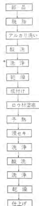
図 3.3 ディップブレージング手順 Fig. 3.3 Dip brazing process.
