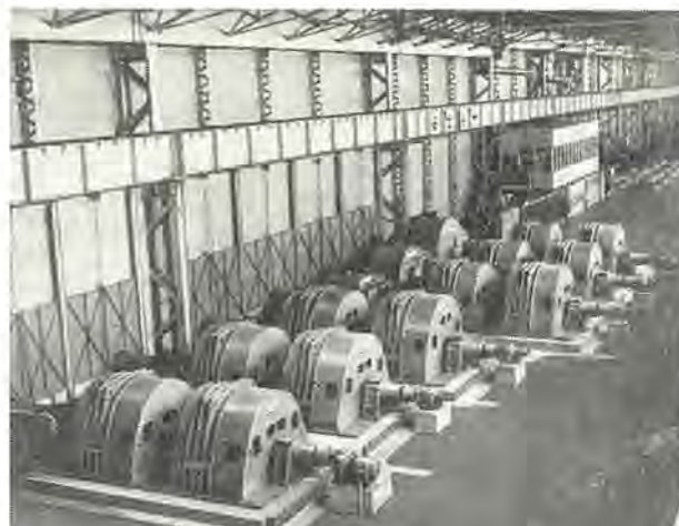
図 3.1 連続式熱間仕上圧延機用電動機 Fig. 3.1 Main Drive DC motors for hot strip finishing stand.
