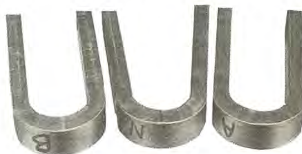
図 4.4 側曲げ試験結果 Fig. 4.4 Test pieces in guided side bend test.
