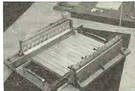
図 3.9 仮付け治具 Fig. 3.9 Tack welding jig.
