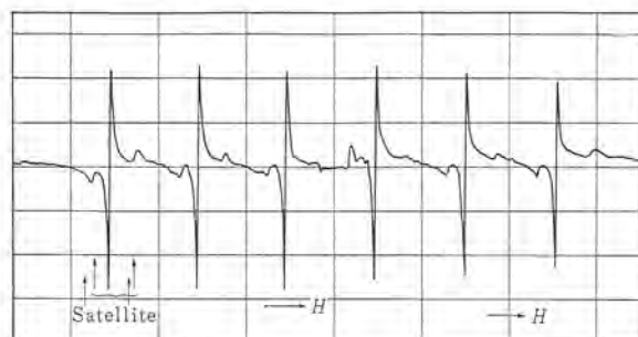
図 3.2 MgO : ( Mn^{4+} , Li) の ESR スペクトル (試料 : M_{3-6} ) Fig. 3.2 ESR spectrum of MgO : ( Mn^{4+} , Li) measured at 77°K. (Sample : M_{3-6} )
