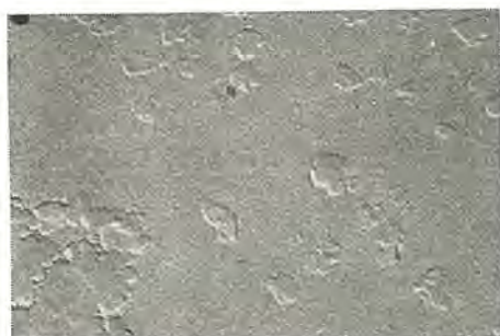
図 4. 1 ソーダ石灰ガラス 600°C 10 分熱処理の表面状態 [ \times 18,000 ]
