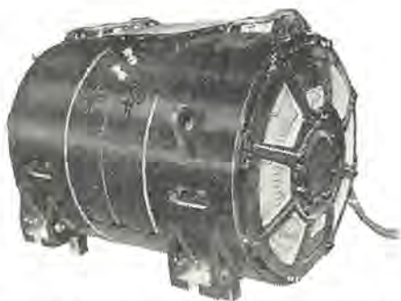
スペイン国鉄向け MB 3200-A 形 1,350 kW 主電動機
