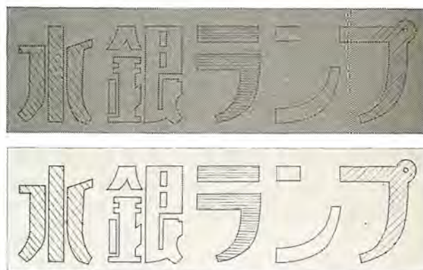
図 5.5 同じ条件の下での複写効果 (上) 複写用水銀灯, (下) \text{GaI}_3\text{-Hg} ランプ Fig. 5.5 Duplicating effect by a conventional mercury lamp and \text{GaI}_3\text{-Hg} lamp. upper : mercury lamp. lower : \text{GaI}_3\text{-Hg} lamp.
