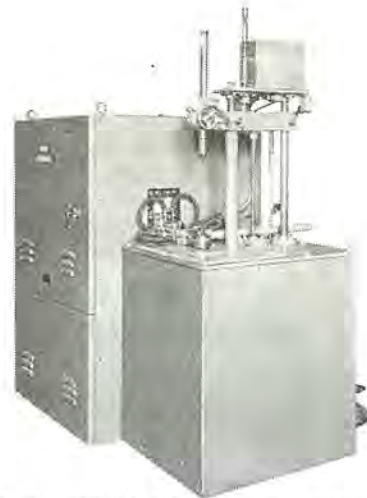
図 5. 6 HM-3 V 1 A 形カムシャフト専用焼入れ機 Fig. 5. 6 Cam shaft hardening machine type HM-3 V 1 A. いて大電力で焼入れるようになってからはほぼ均等な深さに焼入れられるようになり好結果を得ている。図 5. 6 はカムシャフト専用の焼入れ機であるが，焼入コイル，制御回路を切り換えるようにしたら普通の立形焼入れ機で焼入れられることも可能であり実施した例がある。
