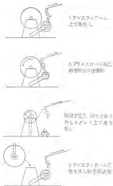
図 3.3 トランスファタイプ巻戻機動作 Fig. 3.3 Transfer type unwinder drive sequence.
