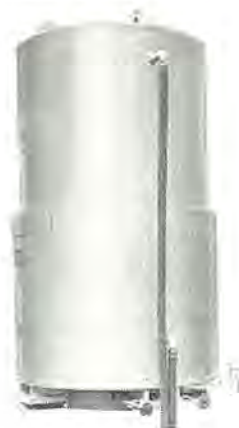
図 3.2 300 kVA, 3,000 c/s 立形高周波発電機 Fig. 3.2 300 kVA, 3,000 c/s vertical type high frequency generator.
