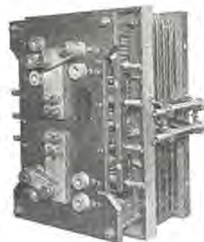
図 5.2 VH 形高周波変圧器（一次端子側） Fig. 5.2 High frequency transformer, VH type Dry, water cooled separate winding type.
