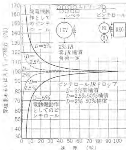
図 2.7 電圧を減少した場合定電流制御での界磁速度あるいは張力の変動
