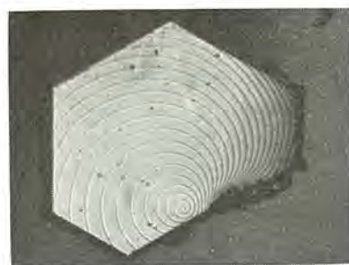
図 2.5 ウズ巻き成長を示す表面模様 Fig. 2.5 Surface pattern showing the spiral growth.
