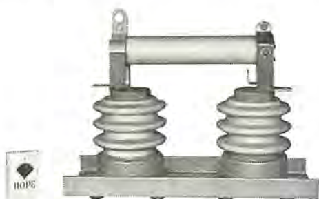
CL 形 7.2 kV 50 A 断流形電力ヒューズ シヤ断容量三相非対称 800 MVA
