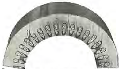
図 3.5 揺変性エポキシ処理固定子の切断面 Fig. 3.5 Section of thixotropic epoxy treated stator.
