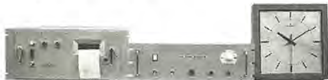
図 3.7 親時計、デジタルプリンタと TV-901 形時刻信号発生器 Fig. 3.7 Type TV-901 time signal oscillator with crystal clock and digital printer.
