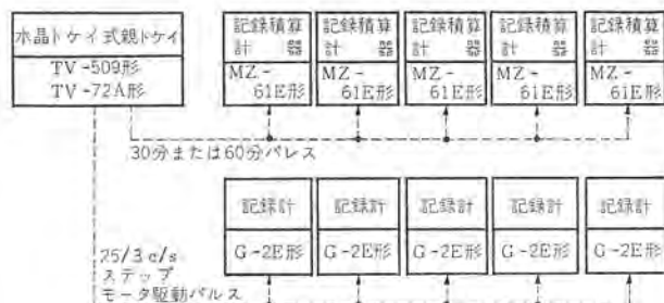
図 3.4 印字式記録積算計と直動式記録計を複数個使用の場合のブロック線図 Fig. 3.4 Block diagram of using a number of printing watt-hour and recording meter.
