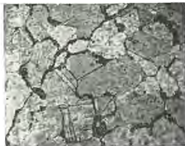
図3.4 試料“M-0”に生じた粒界反応の顕微鏡写真(×300) (70%冷間圧延→840°C×1h溶体化処理→780°C×1.25h→315°C×3h時効処理)
