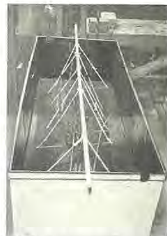
図 3.7 ダイエポキシ 絶縁コイルの海水浸セキの試験状況 Fig. 3.7 Test of Dia-epoxy insulated coil submerging in brine.
