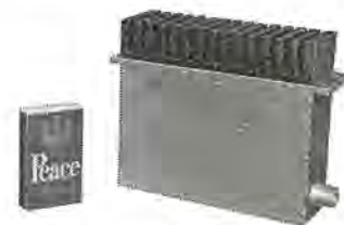
図 2.4 4Gc 0.5W 水晶制御 テイ倍器 Fig. 2.4 4Gc, 0.5 W crystal controlled solid state source.
