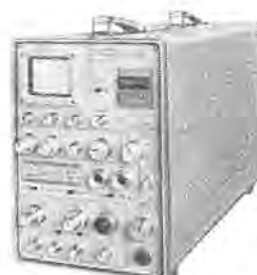
図 1.1 ND-1660 形 200 チャネル波高分析器 Fig. 1.1 Type ND-1660 200 channel pulse height analyzer.
