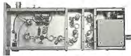
図 6.4 広帯域増幅テイ倍器 Fig. 6.4 Wide-band amplifier and quadrupler.
