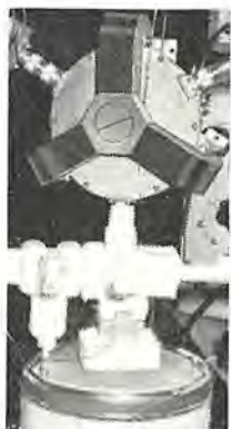
図 13.2 1.6 Gc 液体窒素冷却 パラメトリック 増幅器 Fig. 13.2 1.6 Gc trial parametric amplifier cooled with liquid nitrogen.
