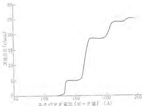
図 4.4 エクスパンダ電流に対するX線出力の変化 Fig. 4.4 Variation of the X-ray output vs. the current of the expander.
