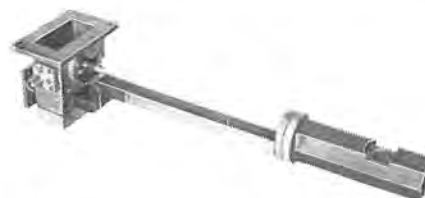
図 13.7 4.2 Gc 冷却用 パラメトリック 増幅器 ヘッド Fig. 13.7 4.2 Gc cooled parametric amplifier head.
