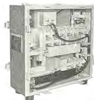
図 8.1 バラクタ、アップコンバータによる 7 Gc 中継機 Fig. 8.1 7.5 Gc, 100 mW solid state heterodyne repeater.
