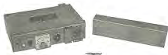
図5.1 安定化送信機 (4Gc 100 mW) Fig. 5.1 Stable solid-state transmitter 4Gc 100 mW.
