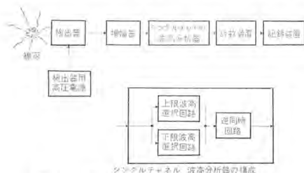
図2.1 放射線エネルギースペクトロメータ構成 Fig. 2.1 Block diagram of nuclear energy spectrometer.
