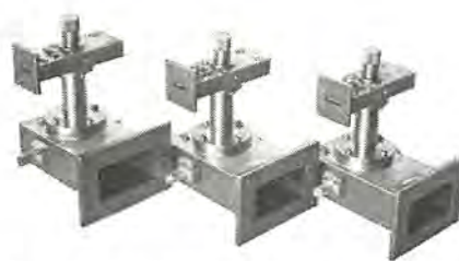
図 13.5 4 Gc 人工衛星自動追尾装置用 パラメトリック 増幅器 Fig. 13.5 4 Gc parametric amplifiers for automatic satellite tracking system.
