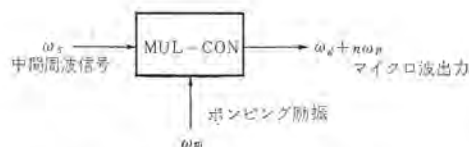
図 8.3 MUL-CON によるヘテロダイン送信機 Fig. 8.3 Newly developed heterodyne transmitter using MUL-CON.
