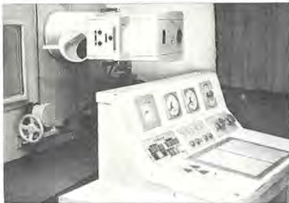
図 4.2 イメージングリファクタと 200 kVp X線装置制御器 Fig. 4.2 Image amplifier and controller of 200 kVp X-ray generator.
