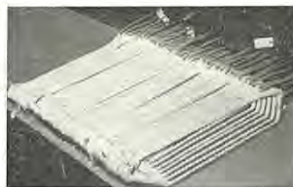
図 4.2 高圧水中モートル用コイル Fig. 4.2 Coil for use in high tension submersible motor.
