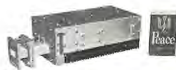
図 2.3 12Gc 100mW 水晶制御 テイ倍 Fig. 2.3 X-Band 100 mW crystal controlled solid state source.
