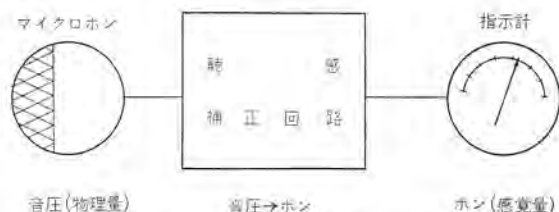
図 2.3 指示騒音計構成説明 Fig. 2.3 Schema of indicating noise meter.
