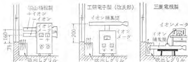
図 5.3 吹出グリルイオン濃度測定法 Fig. 5.3 Ion density measuring method at outlet grill.
