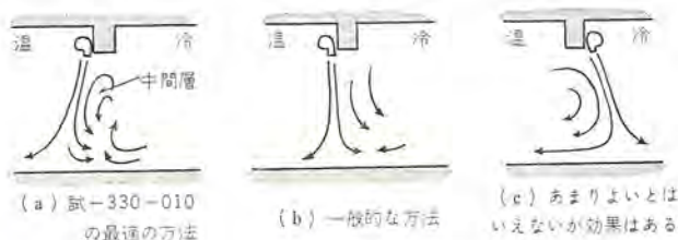
図 2.5 エアカーテンの取付法 Fig. 2.5 Installation of air curtain.
