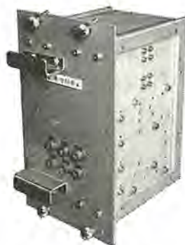
図 6.3 論理回路トレイ外観 Fig. 6.3 View of logic circuit unit.
