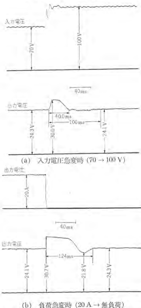
図 4.10 SI51-2 形 DC-DC コンバータ 過渡特性 Fig. 4.10 Transient responses of DC to DC converter, type SI51-2.
