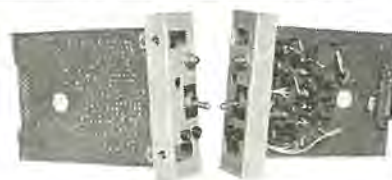
図 3.3 トランジスタ演算増幅器 Fig. 3.3 Transistor operational amplifier.
