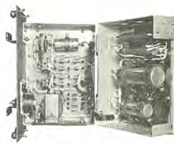
図 5.5 限流制御トレイ内観 Fig. 5.5 Interior view of pattern control unit.
