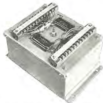
図 3.6 TPM 形点弧装置外観 Fig. 3.6 External view of type TPM gating amplifier.
