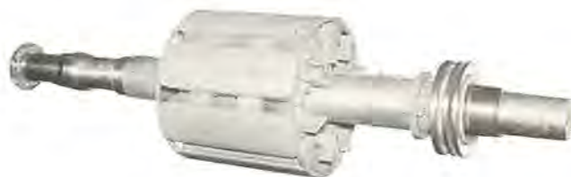
図 2 4,500 kW 同期電動機 ダンパレス形回転子
