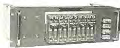
図 3.2 故障表示ブロック Fig. 3.2 Cell failure indicating equipment.
