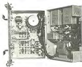
図 4.5 カムモータ制御 トレイ内観 Fig. 4.5 Interior view of pilot motor control circuit.
