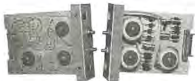
図 3.6 ゲート回路 Fig. 3.6 Gate circuit unit.
