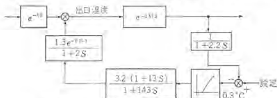
図 3.3 水加熱器制御系ブロック線図 Fig. 3.3 Block diagram of heat exchanger control system.
