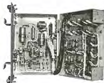
図 6.4 論理回路トレイ内観 Fig. 6.4 Interior view of logic circuit unit.
