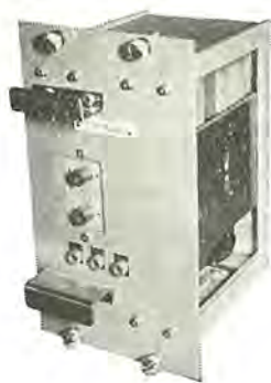
図 4.4 カムモータ制御 トレイ外観 Fig. 4.4 View of pilot motor control unit.
