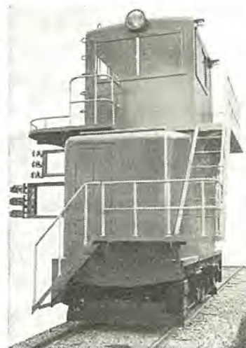
図 6-2 日本水素小名浜工場納め 20 t 消火車ケン引用電気機関車 20 t Quenching electric locomotive.
