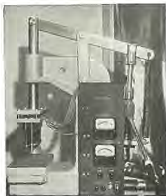
図 20-11 JIS C 2550 の第2法による層間抵抗試験装置 Tester of interlamination resistance by JIS C 2550 method 2.
