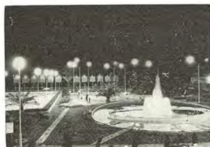
⑱ 名古屋 スポーツガーデン 屋外 ベビーゴルフ場(名古屋) HF-400W 1灯 ポールライト ポールヘッド HP-312 照度 約30lx
