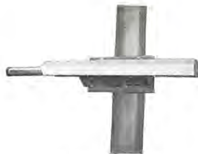
図 14-14 受 光 器 Receiver of gate limiter.
