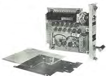
図 11-44 同期分配ユニット Synchronizing distribution unit.
