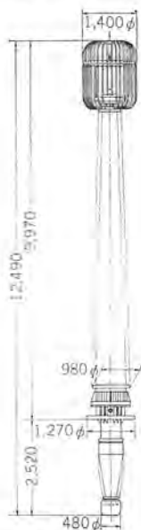
図 2-19 500kV 1,000 A 耐塩害用 ブッシング 外形図形 Outline of 500kV 1,000A salt resistant bushing.
