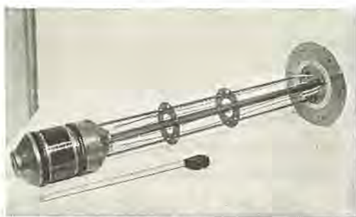
図 20-19 60キロ Gauss 超電導 マグネット 60 k Gauss superconductive magnet.
