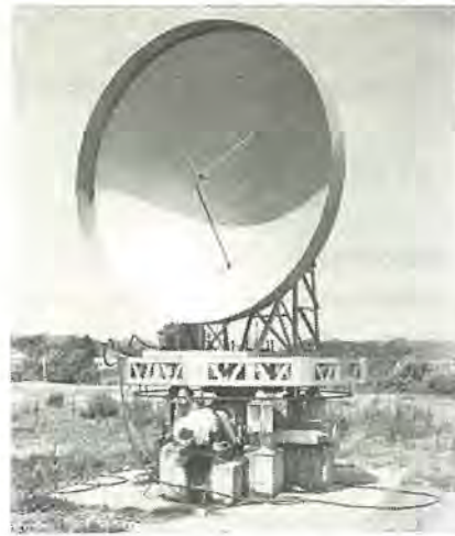
図 11-20 1 本の円形導波管で給電された直交偏波 共用 パラボラアンテナ Parabolic antenna fed by two orthogonal dominant modes in the circular waveguide.
