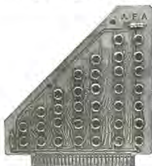
図 20-26 半導体集積回路 TTL による 10 進 1 ケタ 高速加算回路 High-speed decimal adder for 1 digit using integrated cir- cuits, TTL.
