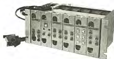
図 12-23 帝都交通営団納め東西線用 ATC 速度照査部 Automatic train control speed checker.
