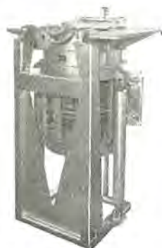
図 4-8 低周波誘導炉 FL230-65 形 Low frequency induction furnace 2,300 kg 650 kW.
