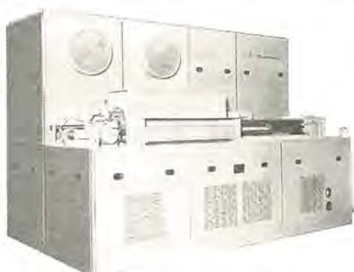
図 4-11 低周波 びれットヒータ 50 c/s 500kVA Billet heater for al-sash extrusion.
