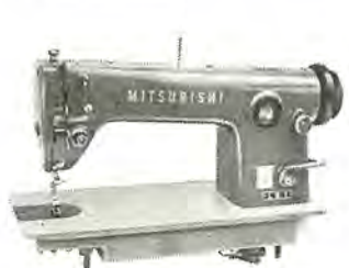
図 17-23 LD 形工業用 差動送り ミシン Type LD industrial differential-feed lockstitch machine.
