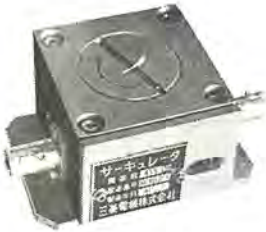
図 11-18 400 Mc 小形 サーキュレータ 400 Mc band miniature circulator.
