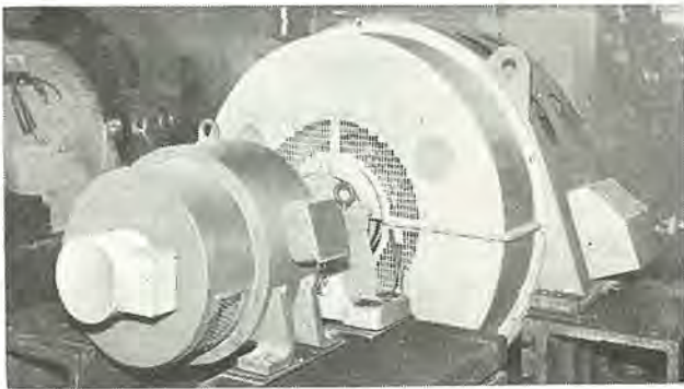
図 1-12 電々公社 (名古屋) 納め 500 kVA 交流発電機 (500 kVA, 6,600 V, 60 c/s, 8 極, 900 rpm) 500 kVA, 6,600 V 60 c/s, 8P, 900 rpm AC generator for Telegraph and telephone public corporation.
