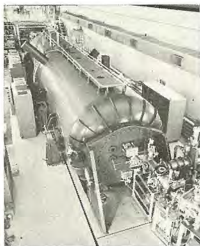
図 19-10 タンデム方式バン・デ・グラーフ形加速器 Tandem type Van-de-graaff accerretator in stalled in Kyōto University.
