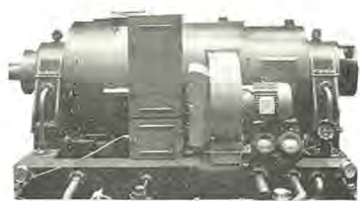
図 4-90 某社向け 600PS 直流電気動力計 600PS 440 V 1,150 A 50,000 rpm 連続定格 600PS direct current electric dynamometer 600PS 440 V 1,150 A 50,000 rpm cont.
