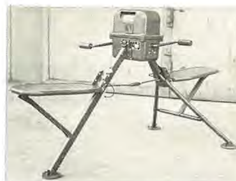
図 11-68 車両とう載用手回わし発電機 Hand operating generator for radio equipment.
