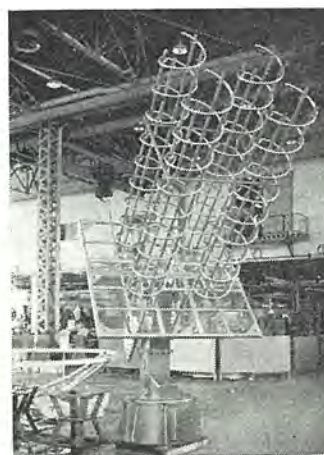
図 11-59 ロケット 用 テレメータ 受信装置の アンテナ Antenna of telemetry receiver for super long range rocket.
