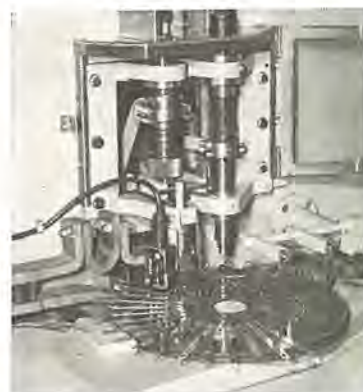
図 4-56 溶接機に用いられた“交流開閉用近接スイッチ” AC proximity switch used welder.
