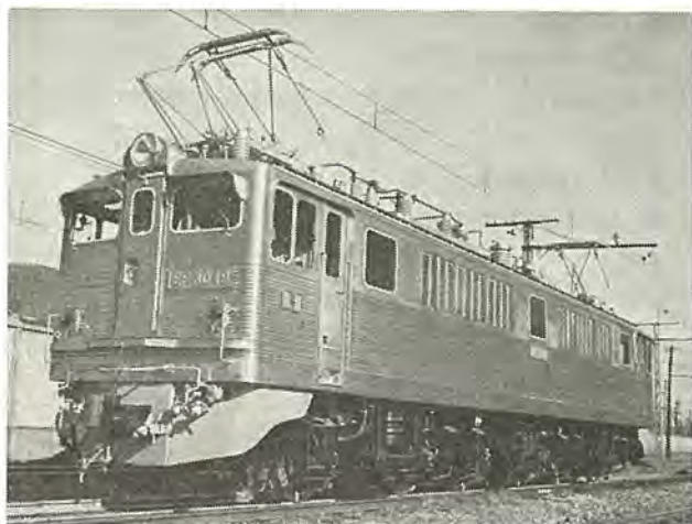
図 6-1 国鉄納め EF30 形交流直両用電気機関車 Type EF30 AC, DC Dual use electric locomotive.
