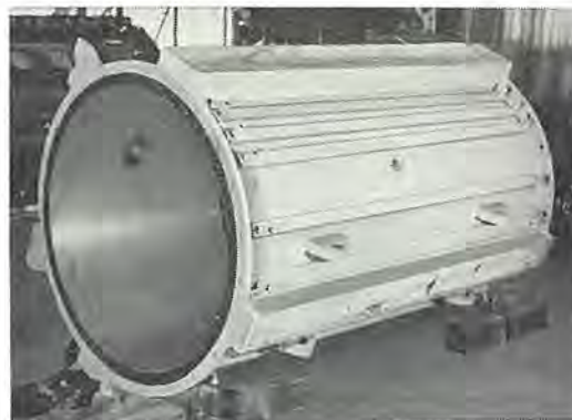
図 19-8 組立前の線形陽子加速器加速空洞 A cavity of the proton linac.
