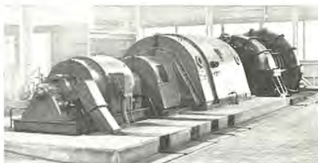
図 4-5 住友金属納め高炉ブロー駆動用 9,200 kW 2 極同期電動機 9,200 kW 2-pole synchronous motor for driving a blast furnace blower.
