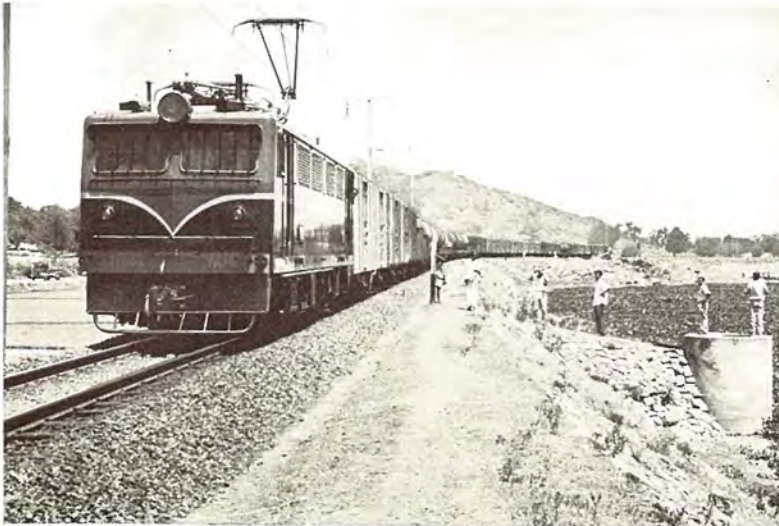
現地で活躍中のメータゲージシリコン整流器式 交流機関車第3号車の偉容 M. G. type AC electric locomotives for the Indian Railways.
