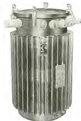
図 2-8 単相 50kVA 50c/s 3kV/210-105V アルミニウム製配電用変圧器 Single phase 50kVA 50c/s 3kV/210- 105V distribution transformer using aluminum materials.
