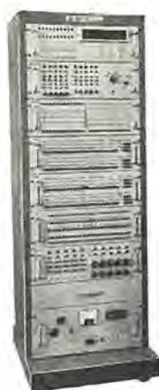
図 12-29 LT-3020 ロジック・トレーナ Type LT-3020 logic trainer.
