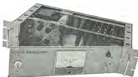
図 19-3 出力領域増幅器 Power range amplifier for nuclear reactor.
