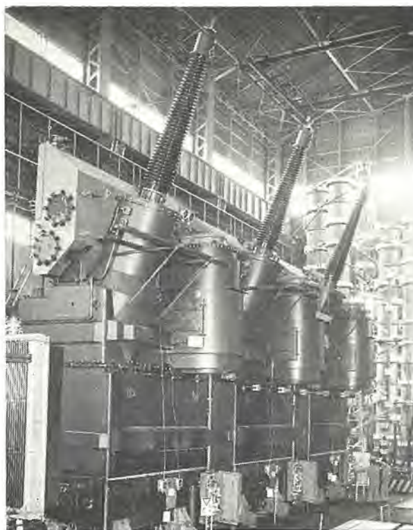
図 2-1 オーストラリア (ECNSW) マンモラ 発電所納め 330kV 400MVA 負荷時タップ切換変圧器 400MVA on-load tapchanging transformer for ECNSW, Australia.
