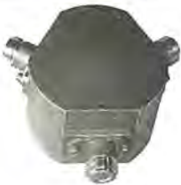
図 11-19 2,000 Mc 同軸 Y 形 サーキュレータ 2000 Mc band coaxial circulator.
