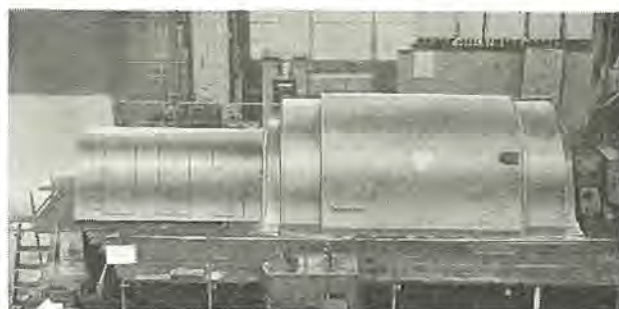
図 1-4 マラヤ連邦 プライ発電所納め 37,500 kVA 空気冷却タービン発電機 37,500 kVA air cooled turbine generator for PRAI power station, Malaysia.
