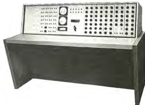
図 12-15 火力プラント 運転員訓練用シミュレータ用指導員盤 Instructor's desk for thermal power plant training simulator.
