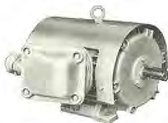
図 4-22 AF-E-W 形安全増防爆屋外形 三相誘導電動機 3.7 kW 4P 200/220 V 50/60 c/s 112 M フレーム Type AF-E-W increased safety induction motor for out-door use.
