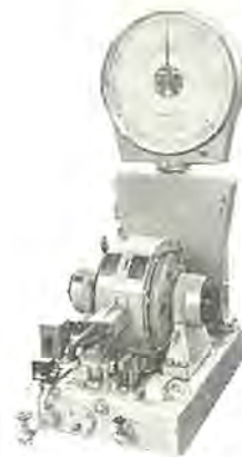
図 4-91 菱重(京都)向け 110 kW ウズ 電流電気動力計 110 kW 2,000/10,000 rpm 連続定格 110 kW eddy current electric dynamometer 110 kW 2,000/10,000 rpm cont.
