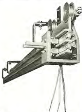
図 2-60 モノレール式トロリーバスダクト 3φ3W AC600V ダクト 100A 集電子 30A Type mono-rail trolley busduct.
