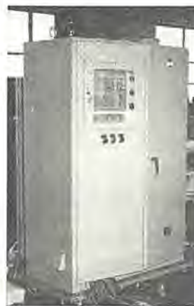
図 4-24 6 サイクル自動ナライ旋盤用 プログラムコントロール制御盤 Control panel for program- controlled lathe.
