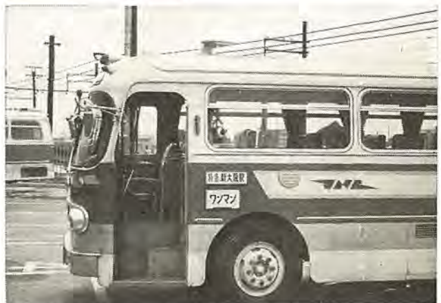
図 11-4 屋根上に装備された複合空中線 JNR Meishin Highway Bus with a new stream-line shape antenna on the roof.
