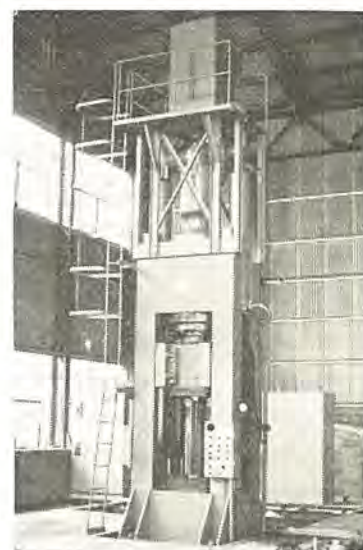
図 4-93 600T 冷間鍛造油圧 プレス 600T hydraulic press for cold forging.
