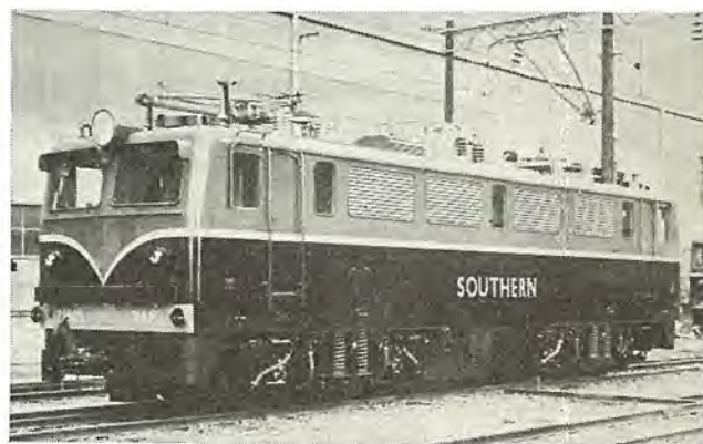
図 6-3 インド国鉄納めメータージ用 52 t 交流機関車 MG type AC electric locomotive for Indian National Railway.
