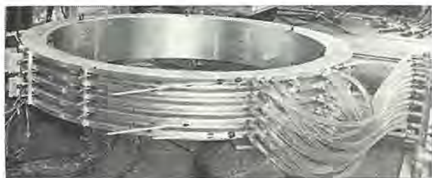
図 19-14 空心 \sqrt{2}\pi 形 \beta 線スペクトロメータ 中 コイル 部 Test-coil of iron-free beta-spectrometer.
