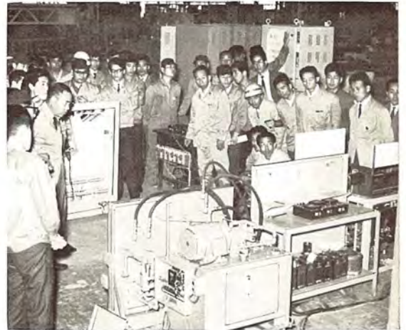
船用ディーゼル主機 自動遠隔操縦装置の立会試験 Automatic remote controls of marine diesel main engine.
