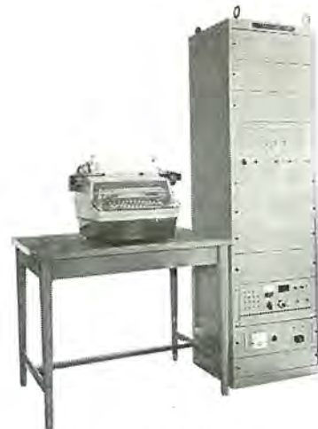
図 11-29 自動気象印字装置外観 Multiple automatic meteorological printer.
