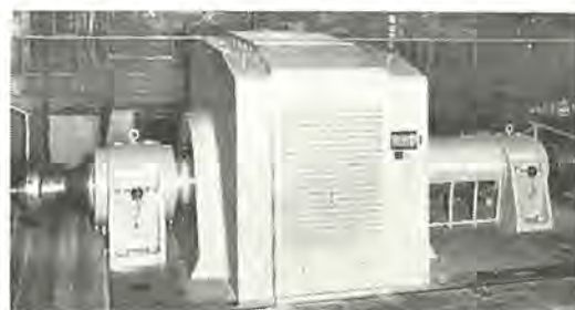
図 4-6 日本鋼管(福山)納め MG 用 12,000 kW 同期電動機 12,000 kW synchronous motor for MG use.
