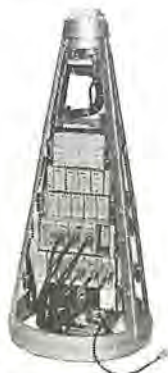
図 11-65 LS-B ロケット 10 CH テレメータ 装置 Telemetry equipment of LS-B rocket, (10 CH FM-FM)
