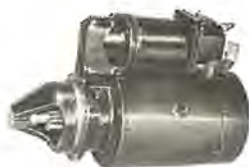
図 7-11 118 φ 2 kW スタータ Yoke diameter 118 φ 2 kW starter.
