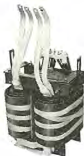
図 2-9 単相 30kVA 60c/s 3kV/210-105V アルミニウムハク・帯使用配電用変圧器 Single phase 30kVA 60c/s 3kV/ 210-105V distribution transformer using aluminum foil and strip.
