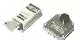
図 4-38 20 W 用静止レオナード 装置 Static Ward Leonard unit for 20 W DC motor.
