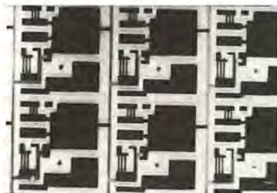
図 20-25 タンタル薄膜CR回路 Tantalum thin-film micro-CR circuit.
