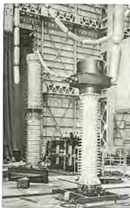
図 2-45 大電流用 PC-25 形 変流器 Type PC-25 current transformer for large current use.
