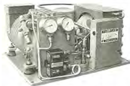
図 10-4 S6A-04 LA 形半密閉形冷凍機 Type S6A-04 LA Semi-hermetic type refrigerating machine.
