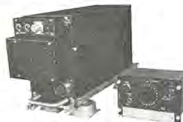
図 11-7 MAR-5 形航空機用無線電話装置、送受信機 および制御器 Radio set type MAR-5. (transceiver & control box)
