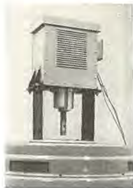
図 5-10 耐振動試験中の OB 形耐衝撃形交流電磁石 Type OB shockproof AC magnet under vibration test.
