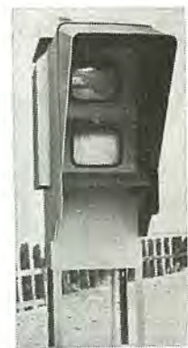
図 11-37 プラットホーム監視用モニタ Television monitor set on the platform.
