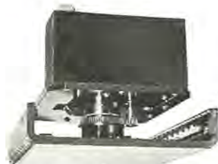
図 11-50 回転ビーム・ドップラレーダ用アンテナ Rotary-beam type doppler radar antenna.
