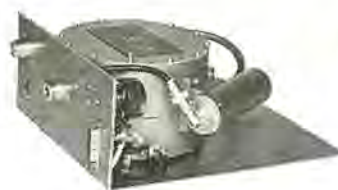
図 11-15 ME-07 A 01, 700 Mc 帯 サテライト用 TDA Type ME-07 A 01, 700 Mc band TDA for UHF-TV satellite.
