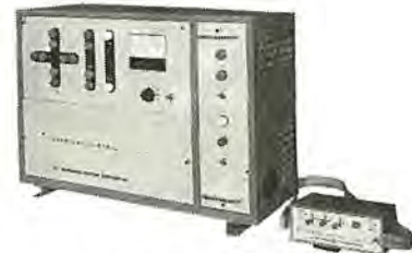
(左)受信機 (右)送信機 図 11-32 クレーン無線操縦装置 Wireless crane controller.
