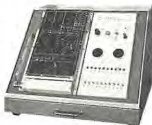
図 12-28 LT-2300 ロジック・トレーナ Type LT-2300 logic trainer.
