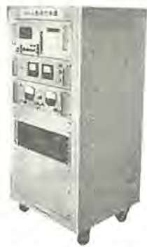
図 4-81 コイル長測定装置盤 Panel for coil length measuring device.
