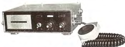
FM-170 形全トランジスタ 400 Mc/FM 無線電話装置 Type FM-170 all solid state 400 Mc/FM radio communication equipment.
