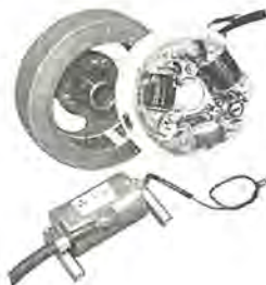
図 7-19 FCF-1BL 形 フライホイール マグネト および HM-1/12C 形 イグニッションコイル Type FCF-1BL flywheel magnet and type HM-1/12C ignition coil.
