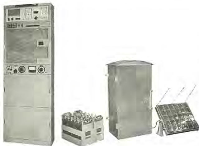
図 11-8 左より ME-40 形無線装置、ME-40 R 中継装置一式 Type ME-40 radio equipment (left), type ME-40 R repeater and solar battery.
