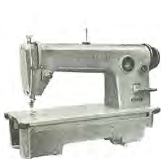
図 17-21 DB-12 形 工業用本縫 ミシン Type DB-12 industrial high-speed single-needle lockstitch machine.
