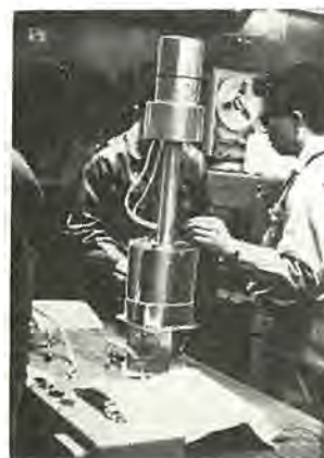
図 20-13 K-9 M-10 ロケット用磁力計 Cesium vapour magnetometer for the rocket type K-9 M-10
