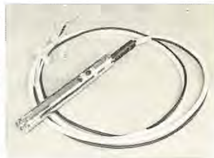
図 14-33 微小電極用小形増幅器 Small size preamplifier for micro electrode.
