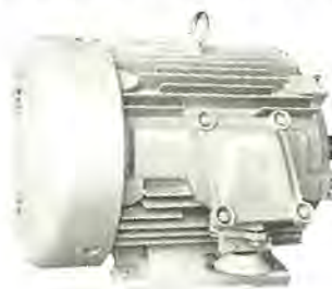
図 4-23 XF 形耐圧防爆形誘導電動機 50 kW 4 極 550 V 60 c/s B 種絶縁 2536 特 フレーム 重量 540 kg Type of flame-proof induction motor.
