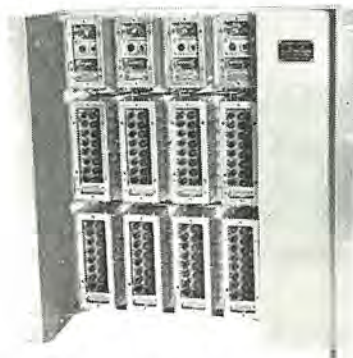
図 11-45 映像切換装置（安定化電源をはずしたところ） Front view of video switching amplifier with power stabilizer removed.
