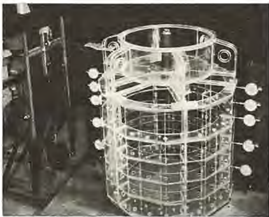
図 20-29 水車発電機 フレーム の プラスチック 模型による剛性実験 Stiffness test of a frame of a water-wheel generator by the use of plastics models.
