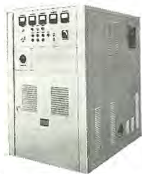
図 12-36 EH-15 R 形 ラジオヒータ Type EH-15 R R.F. generator for induction heating.
