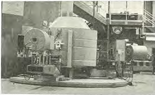
図 19-4 アイオワ大学 エームズ 研究所に据え付けた NX-1309 形複式中性子回折装置 Type NX-1309 double neutron diffractometer installed in Ames Laboratory, Iowa University in U. S. A.
