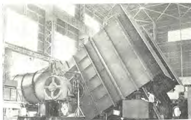
図 4-84 東京電力横須賀 5B 納め FA4094DW ファン Type FA4094DW fan.
