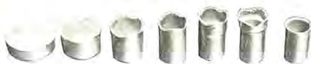
図 18-12 キャップの絞り工程 Drawing process of transistor caps.
