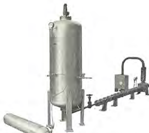
図 19-2 制御棒駆動装置水圧スクラム機構モデルテスト Mock-up test on Hydraulic scram device of control rod drive mechanism.
