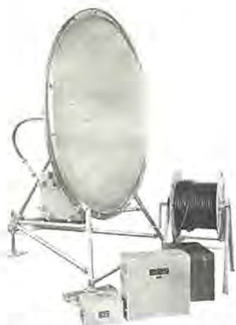
図 11-11 ME-30 形全固体化中継装置 Type ME-30 all solid state microwave repeater.
