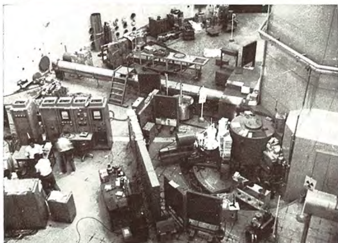
京都大学原子炉の南側に据え付けられた 中性子チョッパと中性子回折装置 Neutron chopper (far side) and neutron diffractometer (near side) installed in south side of Kyōto University Reactor.
