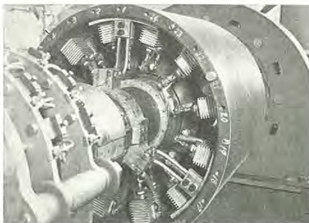
図 1-6 日本カーバイド 魚津工場納め 15,625 kVA ブラシレスタービン発電機用回転整流器 Rotating rectifier coupled to 15,625 kVA turbine generator for Nihon carbide Co.
