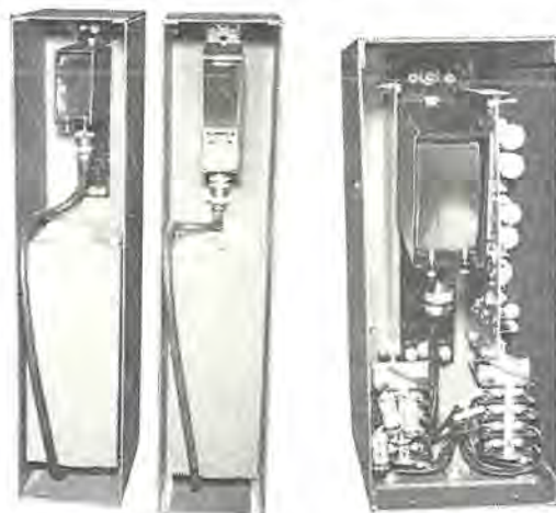
図 5.4 SR形自動車用光電装置 Fig. 5.4 Type SR photo-electric devices for cars.
