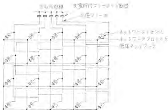
図 2.1 ネットワーク方式実行例 Fig. 2.1 Example of network system.
