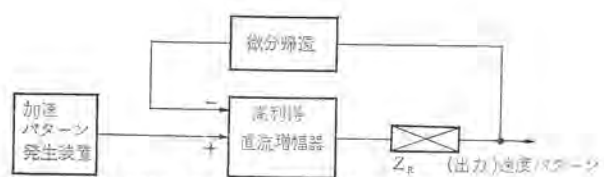
ZR: DMS リアクタを含む減速指令用インピーダンス装置
