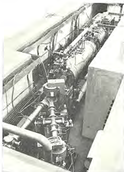
図 1 東北大学納め線形電子加速器試験装置
