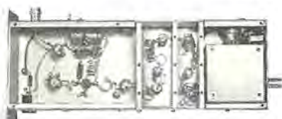
図 2 UHF 用第二局部発振器
