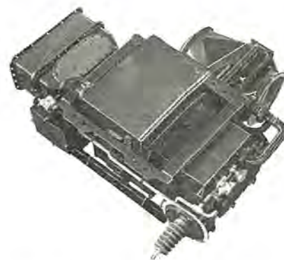
図 7.6 TM-200 形主変圧器 1,650 kVA 25 kV/2,261 V 60 c/s
