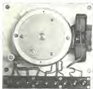
図 4.9 CNP-2 形位相点検継電器 (内部) Fig. 4.9 Type CNP-2 phasing relay.
