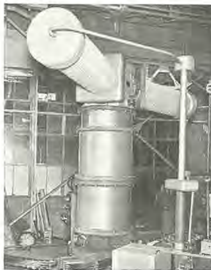
図 4.4 充電用アルミ変圧器 Fig. 4.4 Aluminum transformer for charging condenser.
