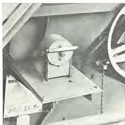
図 4.1 鉱石サージホップ 空量検出装置 線源取付状況
