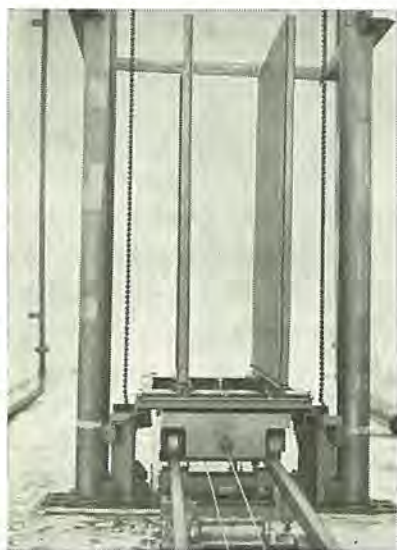
図 3.6 地下水路の底の積み換え位置における線源組立箱をトウ載した台車
