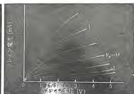
(横軸電圧 0.5V/目盛, 縦軸電流 1 mA/目盛, ゲート電圧 0.5V ステップ) 図 3.4 デプレション形 TFT の静特性 Fig. 3.4 Characteristics of depletion type TFT.
