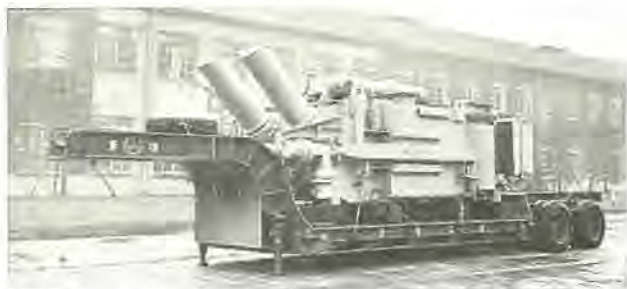
図 3.3 トレーラで輸送中の関西電力単相 30,000 kVA 移動用変圧器
