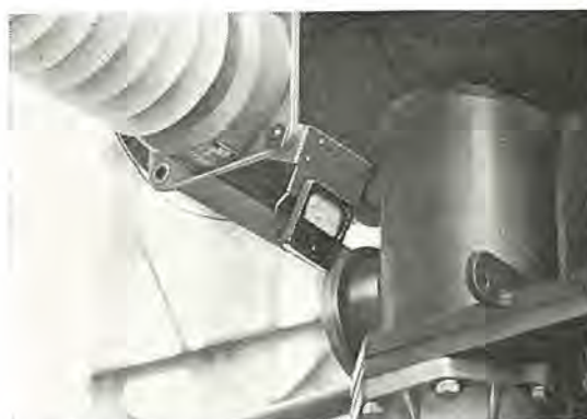
図 5.5 電圧分布測定用 ミリアンペア 計を取り付けた 250-SF-2500 形 SF 6 ガスシヤ 断器 Fig. 5.5 Type 250-SF-2500 SF 6 circuit breaker under measurement of voltage distribution using milliammeter.
