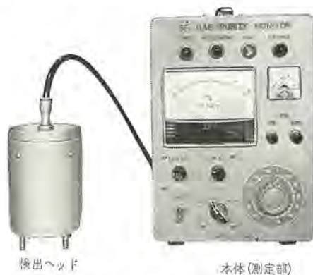
図 5.1 \text{SF}_6 ガス純度測定装置外観 Fig. 5.1 \text{SF}_6 gas purity monitor.
