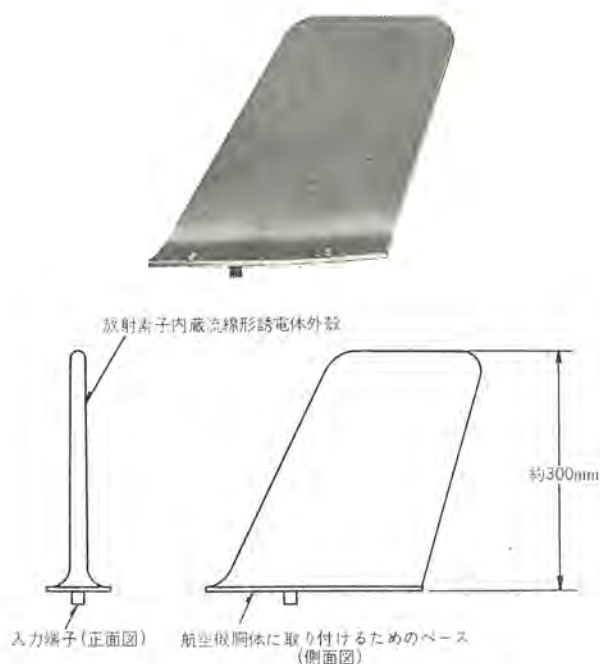
図 3.1 航空機用 VHF ブレードアンテナ 外観 Fig. 3.1 Out side view of the VHF blade antenna for aircraft.
