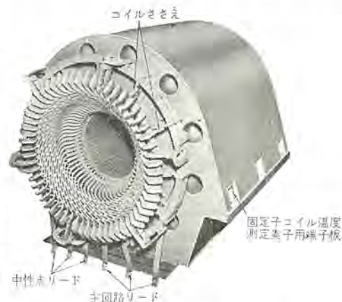
3.2 2 極同期電動機の固定子 Fig. 3.2 Stator of 2-pole synchronous motor.
