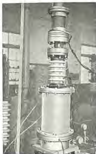
図 2.2 SF 6 吹付形シヤ断器モデル Fig. 2.2 SF 6 gas blast type model interrupter.
