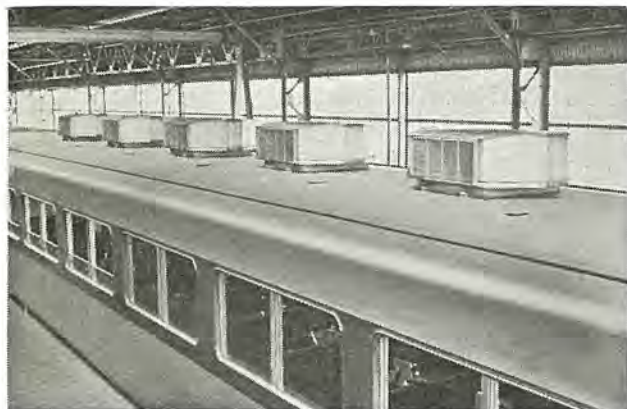
図 2.1 AU-13 形 ユニットクーラ 取付外観 Fig. 2.1 Appearance of the type AU-13 unit cooler installation.
