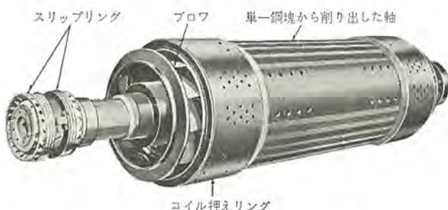
図 3.4 2極同期電動機の回転子 Fig. 3.4 Rotor of 2-pole synchronous motor.
