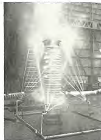
活線スプレー洗浄中の SSV 形 140 kV 避雷器
