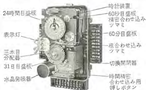
図 5.5 TV-33 形タイムスイッチ構造 Fig. 5.5 Interior of type TV-33Y time switch.
