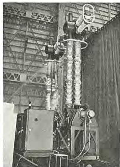
図 4.3 300 kV ガスシヤ断器のジェット洗浄試験状況 Fig. 4.3 300 kV, 25,000 MVA SF 6 circuit breaker in water jet cleaning test in high voltage laboratory.
