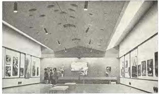
図 4.3 展示室の全景 (天井の左右両側埋込形ケイ光灯とダウンライトを示す)
