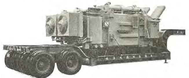
図 2 トレーラで輸送中の移動用変圧器
