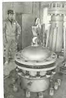
図 4.6 密閉形爆発試験容器とガス混合器
