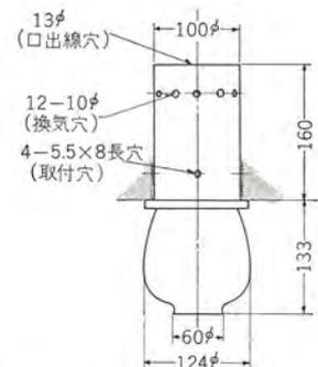
図 4.15 半埋込ダウンライト器具 (100 V, 60 W 電球)
