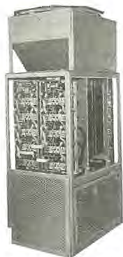
図 5.1 主 SCR 箱 Fig. 5.1 Main SCR box.
