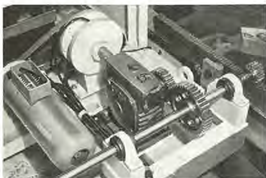
図 4.6 キャリッジ駆動機構 Fig. 4.6 Carriage scanning mechanism.
