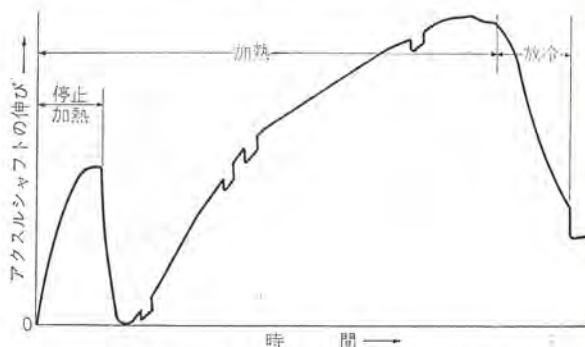
図 4.5 焼入中のアクスルシャフトの伸びの変化 Fig. 4.5 Expansion characteristic of an axle-shaft under hardening.
