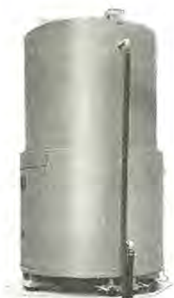
図 5.1 立形高周波電動発電機 Fig. 5.1 Vertical type high frequency motor generator.
