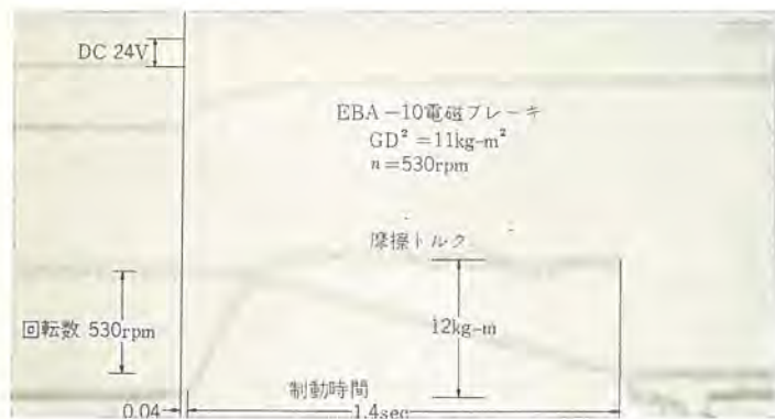
図 5.1 摩擦トルク特性オシロ Fig. 5.1 Friction-torque characteristic oscillogram.
