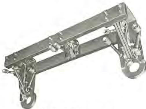
図 4.9 固定形焼入コイル Fig. 4.9 Hardening coil.
