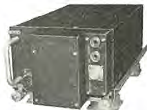
図 3.1 送受信機 MRT-5/MAR-5 外観図 (防振台 MMT-5/MAR-5 付) Fig. 3.1 Receiver-transmitter MRT-5/MAR-5 with shock mount MMT-5/MAR-5.
