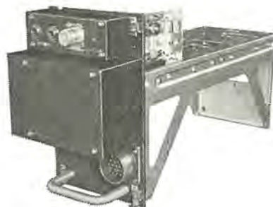
図 4.5 箱 体 部 (水晶切換部付) Fig. 4.5 Main chassis with crystal selector subassembly.
