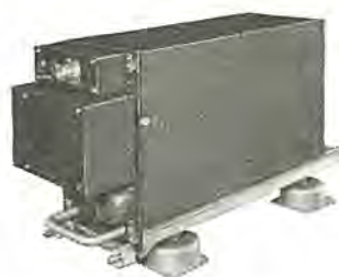
図 3.2 送受信機 MRT-5/MAR-5 外観図 (防振台 MMT-6/MAR-5 付) Fig. 3.2 Receiver-transmitter MRT-5/MAR-5 with shock mount MMT-6/MAR-5.
