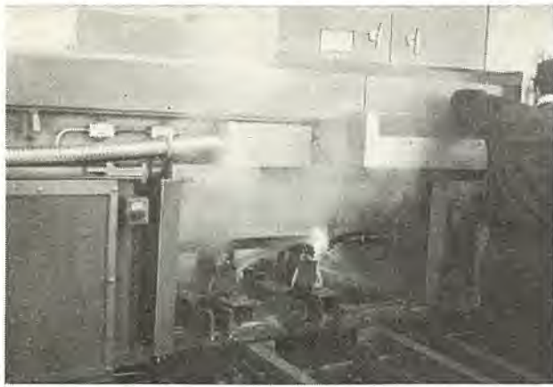
図 6.3 焼入中の低ヒズミ焼入機 Fig. 6.3 Low distortional axle-hardening machine.
