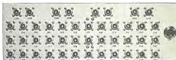
図 3.3 同期信号分配器 (接セン: M 形) 背面外観図 Fig. 3.3 Synchronizing signal distributor (connector: type M), rear view.
