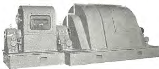
6,000 kW 2 極 三相誘導電動機
