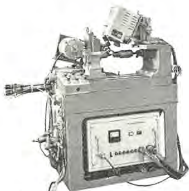
図 1.1 アンダカッティングマシン Fig. 1.1 Fully automatic undercutting machine.
