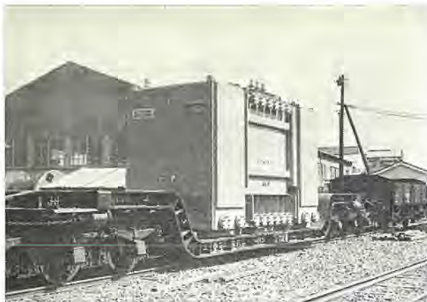
図 7.3 9.9 MW, 60 kA レクチフォーマの組立輸送 Fig. 7.3 9.9 MW, 60 kA rectifier shipped assembled.
