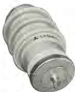
図 3.12 動作責務破壊試験後の試料 (公開立会試験時に機圧上昇法により 破壊させたもの)
