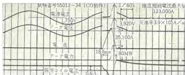
図 5.7 交流等価シヤ断試験オシログラム (推定短絡電流最大値 123,000 A CO 動作) Fig. 5.7 Oscillogram of AC equivalent interrupting test (maximum prospective fault current 123,000 A).
