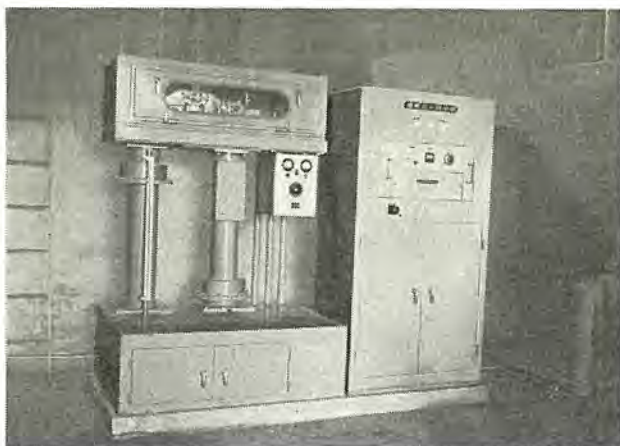
図 3.3 セキ 水位 測定 装置 Fig. 3.3 Level measuring equipment of square weir.
