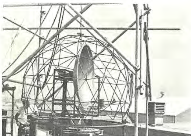
図 3.3 金属骨多面体 レードーム 1/4.2 縮尺模型電気試験 Fig. 3.3 Measuring electrical performance by using 1/4.2 scale radome.
