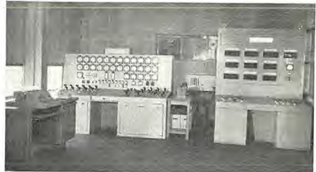
図 2.4 高落差水車試験装置操作盤および計測盤 Fig. 2.4 Central operation room.
