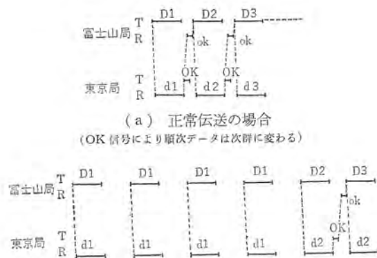
図 6.1 伝送符号 (1 群) Fig. 6.1 Form of transmission code.
