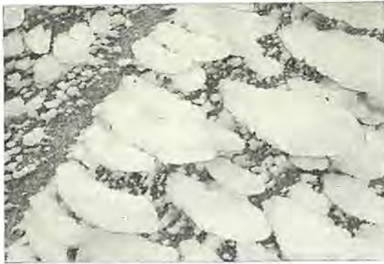
図 4.15 (a) 富士山頂でパネルに付着した霧氷 Fig. 4.15 (a) Rime ice attached to the panel.
