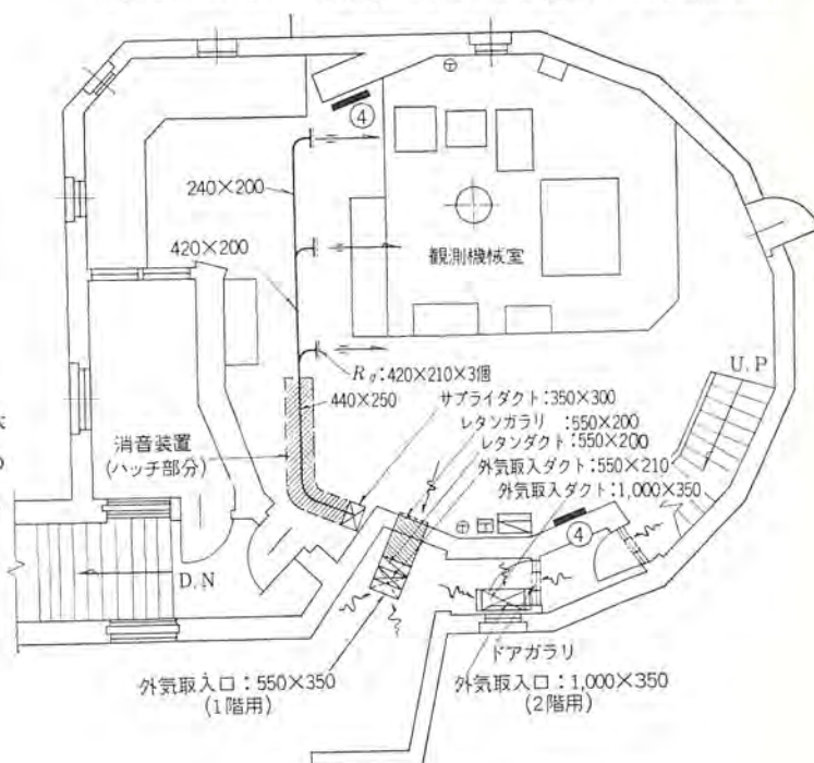
図 6.1 1 階 ダクト 配管図 (1/130) Fig. 6.1 Ground floor ducting.
