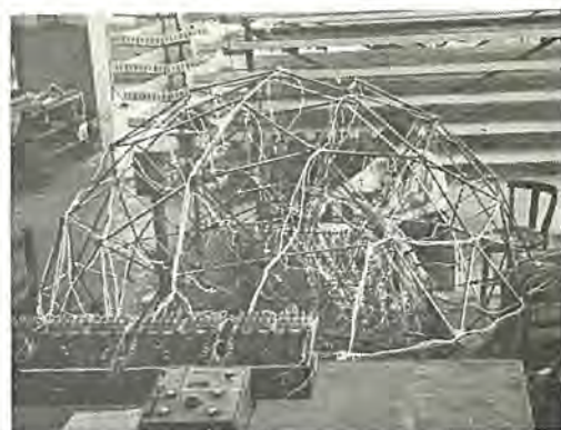
図 4.6 1/7.5 模型による荷重試験 Fig. 4.6 Loading test on 1/7.5 scale model.
