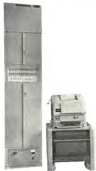
図 2.2 気象 テレメータ 東京局装置 Fig. 2.2 Telemeter equipment of Tōkyō station.
