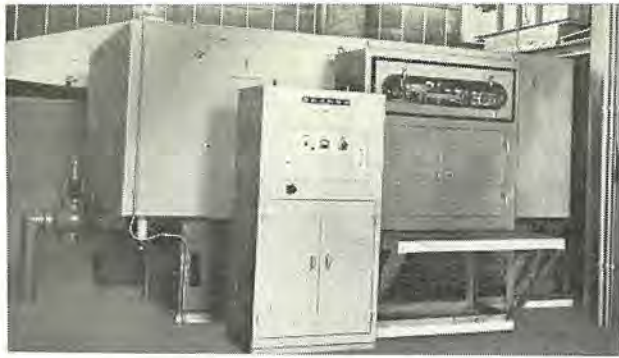
図 2.3 絶対シヨウ(秤)量装置 Fig. 2.3 Absolute measurement apparatus of water discharge.
