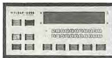
図 7.4 オペレータコンソール 操作 パネル Fig. 7.4 Operator's console request panel.
