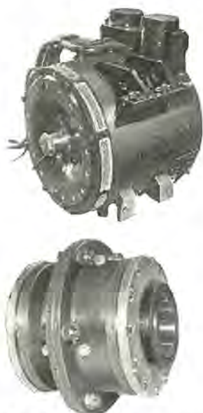
図 4.6 WN-560-BK 形 ギヤカップリング Fig. 4.6 Type WN-560-BK gear coupling.
