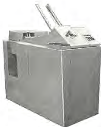
図 2.7 MELCOM-1564 高速カード・リーダ・パンチ Fig. 2.7 MELCOM-1564 high speed card reader and punch.
