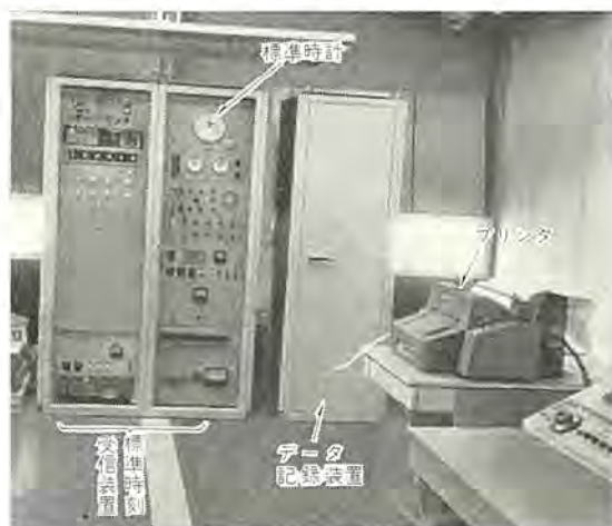
図 4.16 標準時刻受信装置、データ記録装置およびプリンタ Fig. 4.16 Standard time receiver (left), data recorder (center) and printer (right) in telemeter center.
