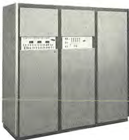
図 2.1 MELCOM-1530 プロセッサ および MELCOM-1540 バッファ・コントローラ Fig. 2.1 MELCOM-1530 processor and MELCOM-1540 buffer controller.
