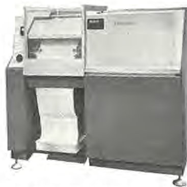
図 2.9 MELCOM-1560 高速ライン・プリンタ Fig. 2.9 MELCOM-1560 high-speed line printer.
