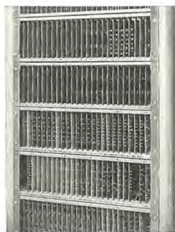
図 1.2 カード実装パネル Fig. 1.2 Assembling panel of high NOR card.
