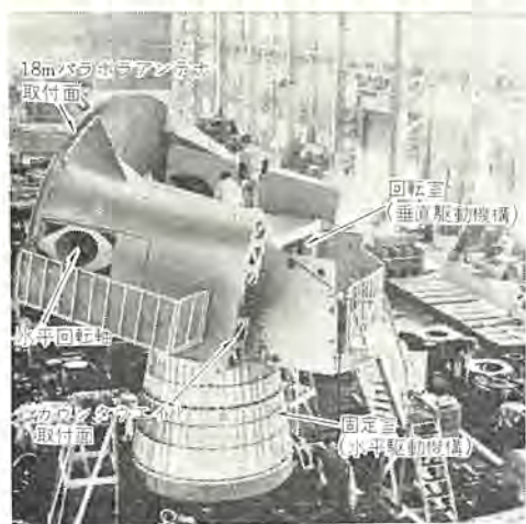
図 4.10 空中線駆動部組立 (当社神戸製作所) Fig. 4.10 Drive mechanism assembling in Kobe works, for teletype tracking radar.
