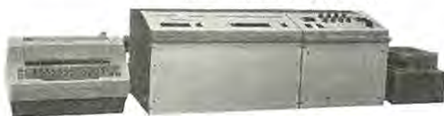
図 3.1 モレクトロン 計算機 (左から タイプライタ、本体、電源、テープリード) Fig. 3.1 MOLECTRON computer (from left to right: Typewriter, processor, power supply and phototape reader).
