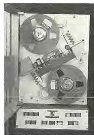
図 2.3 磁気テープ・トランスポート Fig. 2.3 Magnetic tape tape transport.
